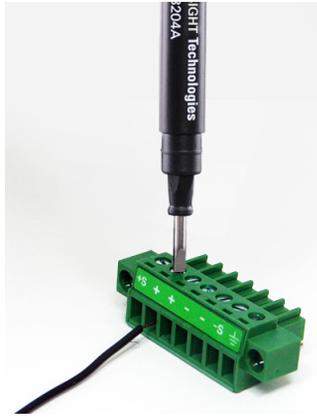
*Не используйте экран в качестве одного из измерительных проводов. Заземляйте экран только со стороны U3606B. Другой конец экрана должен быть оставлен неподключенным. Необходимо соблюдать полярность при подключении проводов измерения к нагрузке. Выходные провода можно подключать к любой из двух клемм «+» или «-». Они соединены внутри.*
