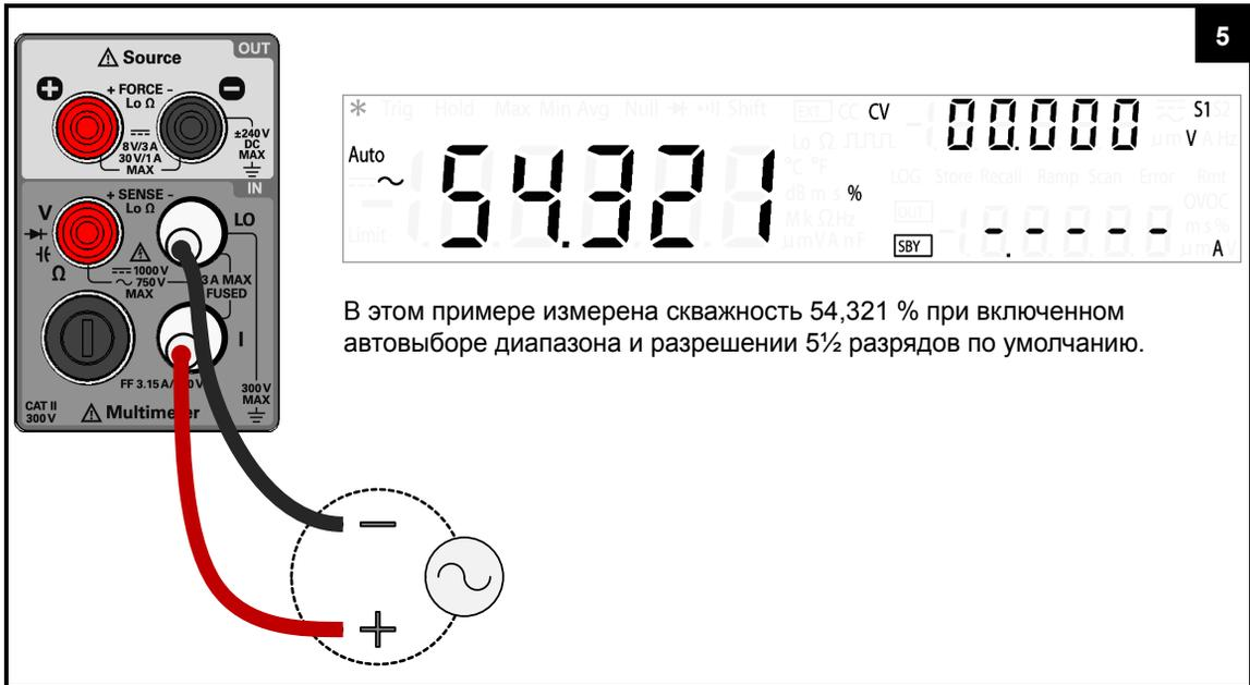
**ВНИМАНИЕ!** Если измеряемая частота сигнала ниже 20 Гц, следует вручную выбрать диапазон переменного напряжения или переменного тока для получения стабильного показания.
