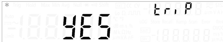
Функции ЗПН и ЗПТ зависят от функции состояния защиты выхода. Защита выхода должна быть включена, чтобы функции ЗПН и ЗПТ были активны. Отключение защиты выхода деактивирует функции ЗПН и ЗПТ, даже если задан уровень отключения для ЗПН или ЗПТ.
