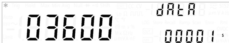
Функция регистрации данных обеспечивает удобную запись тестовых данных для последующего просмотра или анализа. Поскольку данные сохраняются в энергонезависимой памяти, они сохраняются, даже если выключить U3606B.
