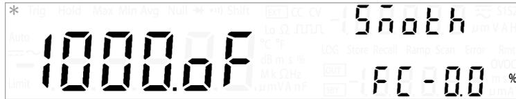
Функция сглаживания представляет собой специальное краткосрочное усреднение, которое отличается от функции усреднения операции MinMax. Функция сглаживания отфильтровывает шум и стабилизирует показания. Функция усреднения операции MinMax представляет собой долгосрочное усреднение, так как использует для усреднения все измерения.
