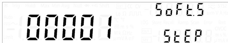
U3606B позволяет выполнить плавный запуск источника питания постоянного тока. Для настройки плавного пуска выхода можно выбрать значение от 1 до 10000 шагов. Эта функция полезна при запуске двигателя постоянного тока. Заводское значение шага плавного запуска равно 1.
