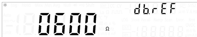
Функция dBm является логарифмической и основана на расчете мощности, выделяемой на эталонном сопротивлении, относительно 1 мВт.
