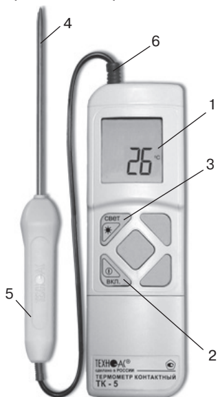
Рис. 1 Основные части прибора ТК-5.01, органы управления.
