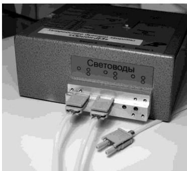
Рис 7. Установить оптические коннекторы в оптический блок.
