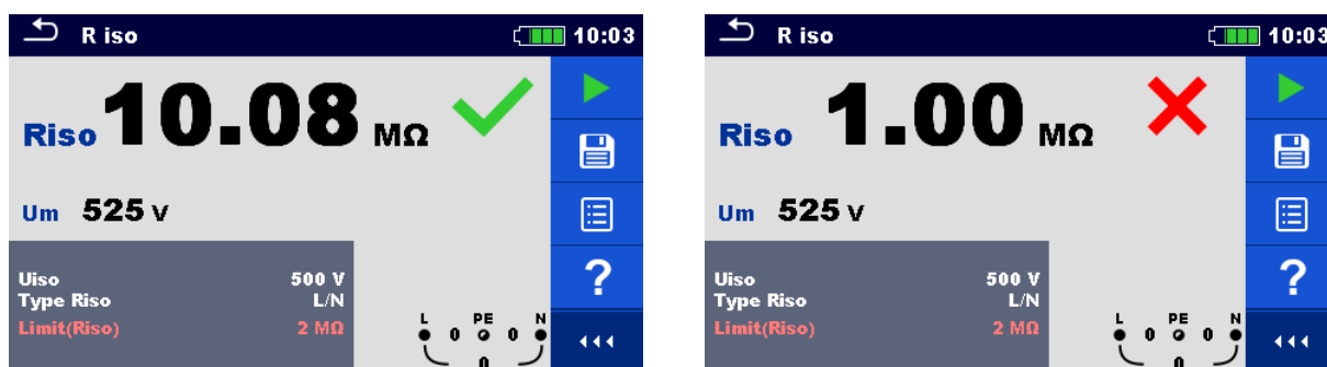
Рисунок 7.9: Примеры результатов измерения сопротивления изоляции.
