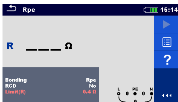
Рисунок 7.74: Меню измерения сопротивления провода защитного заземления.
