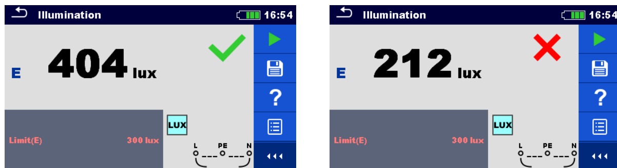
Рисунок 7.79: Пример результата измерения освещенности.
