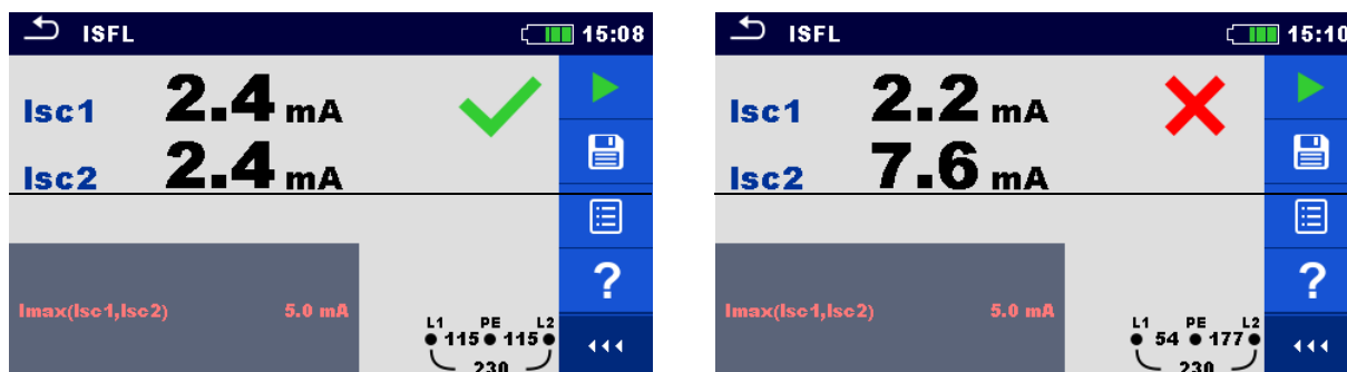
Рисунок 7.70: Примеры результатов измерения тока утечки первичного повреждения.
