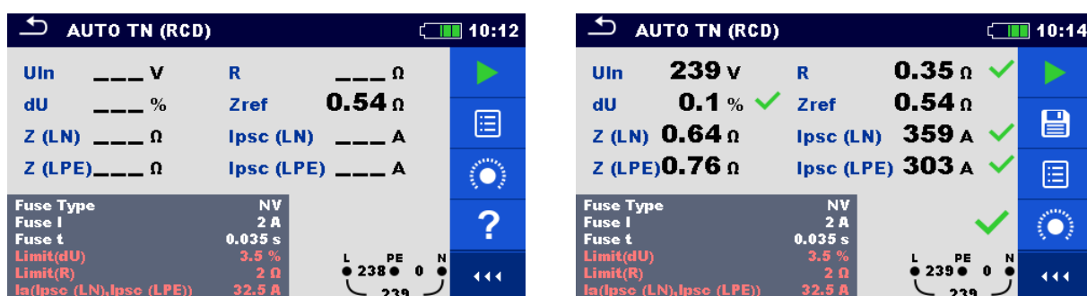
Рисунок 8.8: Примеры результатов измерения АВТО TN (УЗО).
