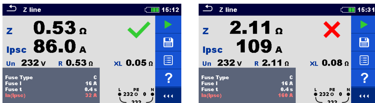
Рисунок 7.40: Примеры результатов измерения полного сопротивления линии.
