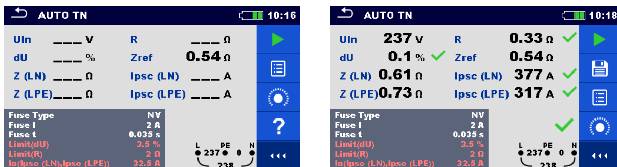
Рисунок 8.11: Примеры с результатов измерения АВТО TN.
