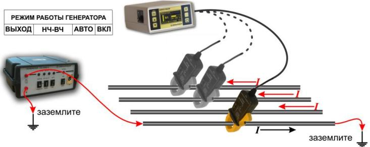
При работе на «холостом» ходу возможна значительная наводка на соседние жилы и отбор кабеля индуктивным определителем затруднен. В этом случае рекомендуется воспользоваться емкостным отборником, ориентируясь на максимальный сигнал.
