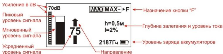
Расположите антенну в положение по максимуму, расположение кабеля определяется по максимальному уровню сигнала точно также как и в режиме «КЛАССИЧЕСКИЙ» режим поиска. Измерения сопровождаются непрерывным контролем глубины и силы тока.
