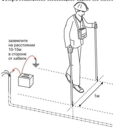
штырей следует заглублять в грунт точно над кабелем, а второй - слева или справа перпендикулярно трассе на расстоянии примерно 1 м. Наблюдайте за уровнем сигнала. При приближении к повреждению, уровень сигнала будет расти, а при удалении плавно падать. Повреждение находится в точке с наибольшим уровнем сигнала.
