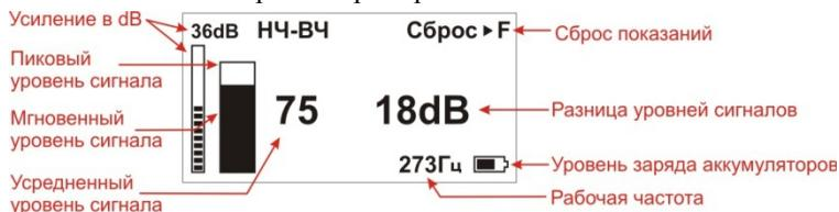
По максимальному уровню сигнала найдите точное положение кабеля. Значение dB на дисплее покажет, есть ли повреждение, 36dB – нет повреждения, меньше – есть. При движении вдоль исправного участка кабеля (трубы) значение будет неизменно, при прохождении места повреждения значение в dB уменьшится. Уменьшение более 4-5dB стоит расценивать как наличие повреждения. Чем более низкое значение достигнуто, тем более низкоомное повреждение присутствует.
