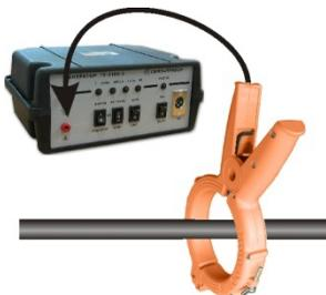
При подключении генератора при помощи клещей-индуктора достигается более высокий уровень сигнала в линии и значительно снижается влияние на соседние магистрали. Клещи представляют собой индукционную катушку с разъемным магнитопроводом, который замыкается вокруг тестируемого кабеля.
