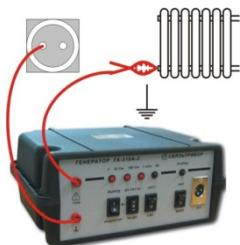
**способ 1:** вывод генератора подключить к жиле скрытой проводки, второй вывод к этой же жиле на дальнем конце проводки (например, провод теплых полов)
