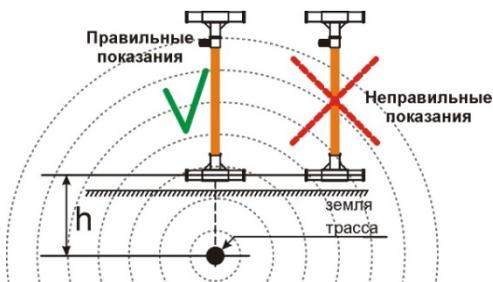
Не проводите определение глубины залегания коммуникации вблизи поворотов, отводов или тройников. Отступите, по крайней мере, 5 м от поворота или отвода для получения максимальной точности.
