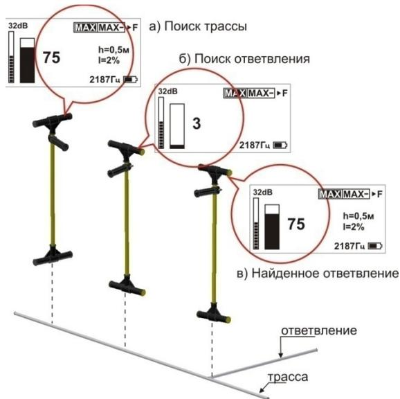
Установите режим работы приемника – **«КЛАССИЧЕСКИЙ»**. Производите поиск трассы как описано ранее. Одновременно проводите поиск ответвлений, располагая антенну параллельно трассе, как показано на рисунке. В этом случае уровень сигнала от «своего» кабеля будет минимален, а ответвления будут вызывать значительный рост уровня сигнала.
