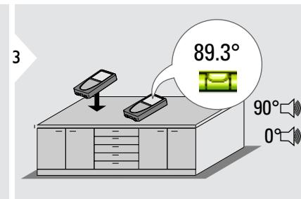
Угол наклона отображается постоянно. Прибор подает сигнал при углах 0° и 90°. Идеально подходит для регулировки горизонтали или вертикали.
