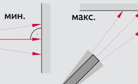
Измеренное минимальное и максимальное расстояние отображается на дисплее (мин, макс). Последнее измеренное расстояние отображается в итоговой строке.
