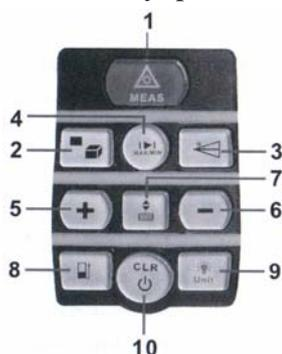
1. Кнопка включения прибора/измерения
