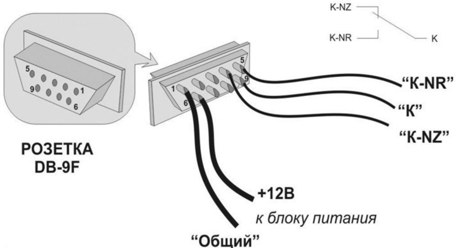
**Схема 3 кабеля для Пульта «КЕЛЬВИН АРТО» Подключение блока питания и СОМ-порта компьютера для регистрации (5-10 метров)**
