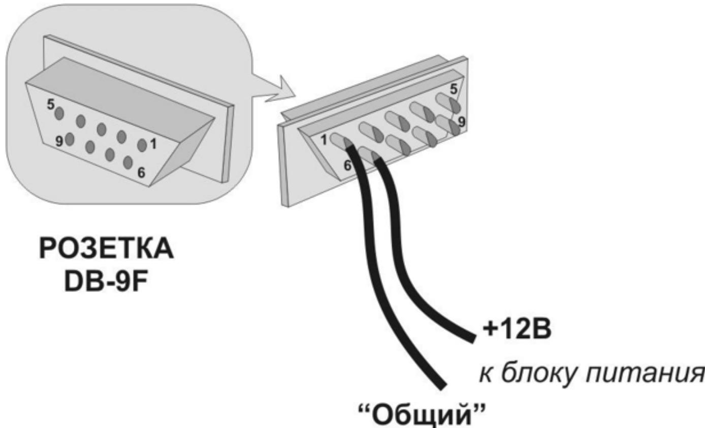
**Схема 2 кабеля для Пульта «КЕЛЬВИН АРТО» Подключение блока питания и контактов встроенного реле**
