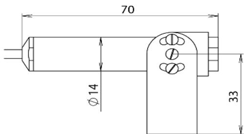
Миниатюрный бесконтактный датчик температуры
