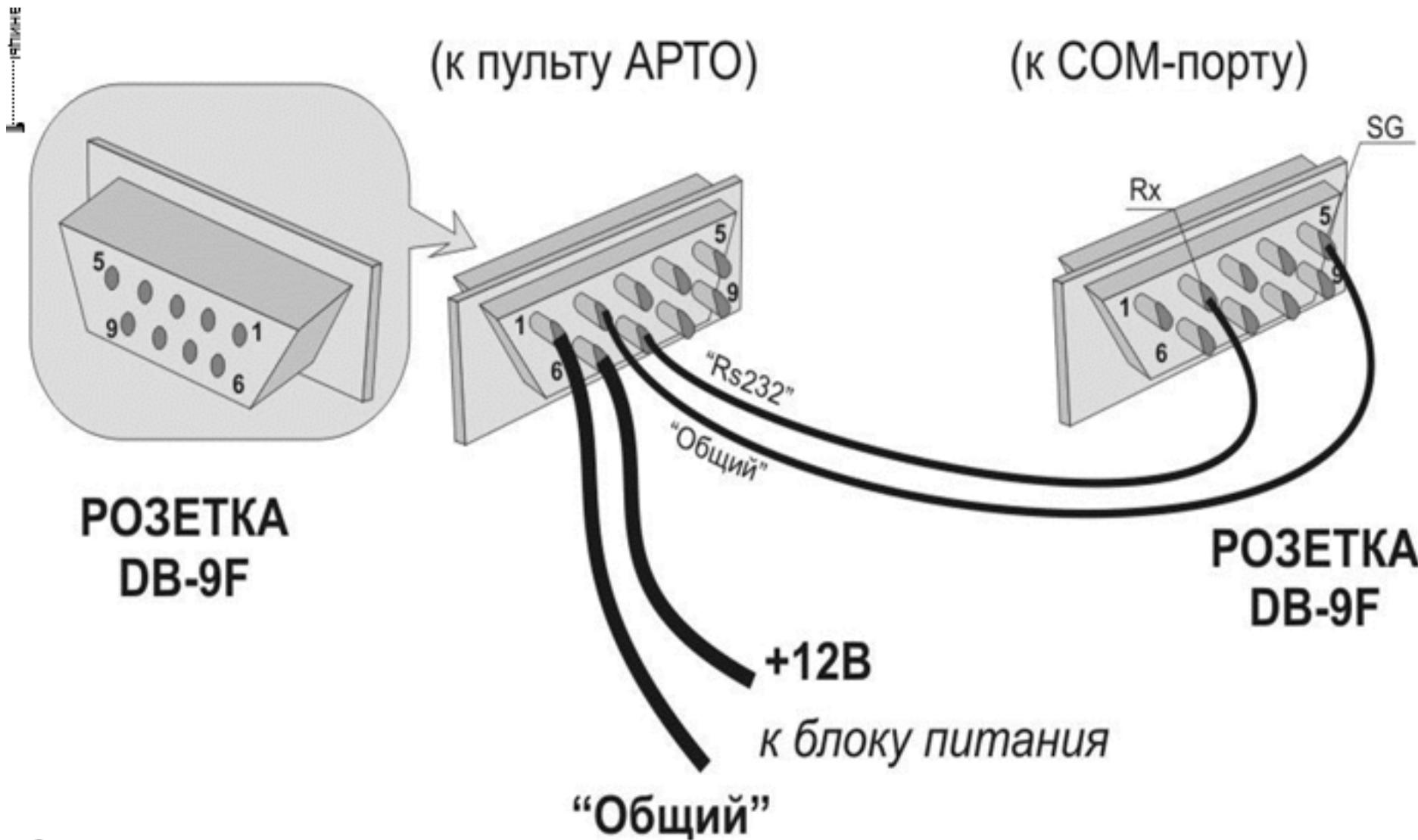
**Схема 4 кабеля для Пульта «КЕЛЬВИН АРТО» Подключение блока питания и внешнего преобразователя в интерфейс «Токовая петля 4-20mA» CL 4-20**
