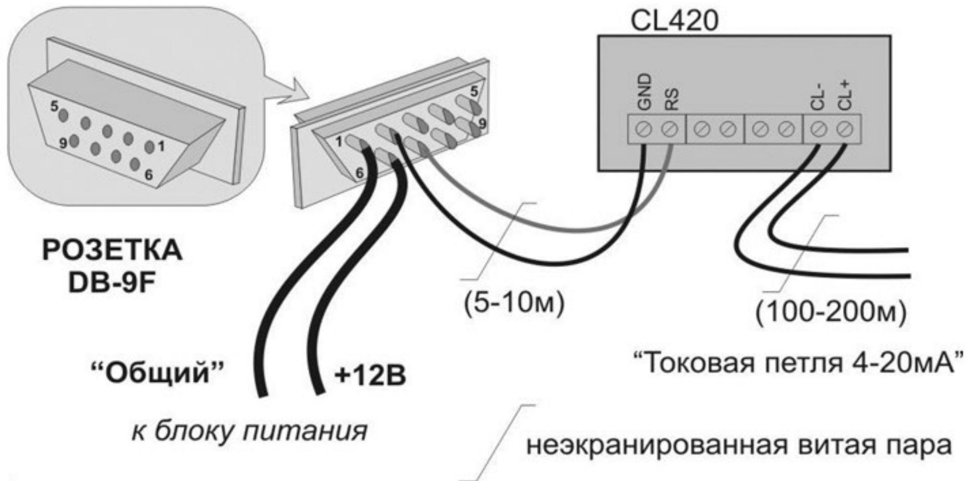
**Схема 5 кабеля для Пульта «КЕЛЬВИН АРТО» к Датчику Ц (модель АРТО 350Ц) Подключение датчика Ц (цифровой)**
