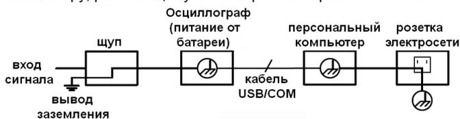
Не допускается измерение мощности переменного тока, если осциллограф с питанием от электросети через адаптер постоянного тока, или если осциллограф с питанием от батареи подключен через порт к компьютеру, запитанному от электросети переменного тока.
