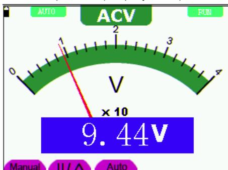
Рисунок 32. Измерение переменного напряжения
