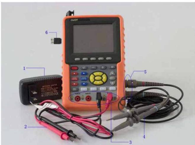
Рисунок 2. Входные разъемы и устройства
