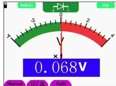
Рисунок 28. Проверка диода
