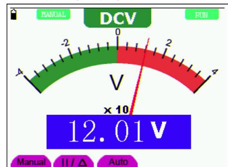
Рисунок 39. Переключение между автоматическим и ручным выбором предела измерения
