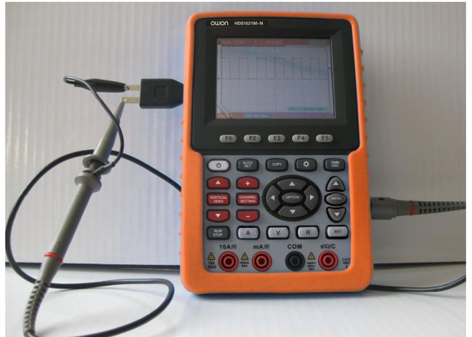
Рисунок 3. Подсоединение тестового прямоугольного сигнала
