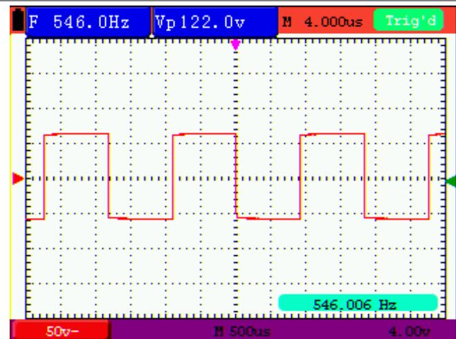
Рисунок 51. Функция частотомера
