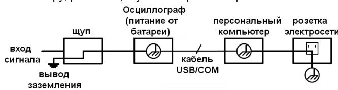
Не допускается измерение мощности переменного тока, если осциллограф с питанием от электросети через адаптер постоянного тока, или если осциллограф с питанием от батареи подключен через порт к компьютеру, запитанному от электросети переменного тока.
