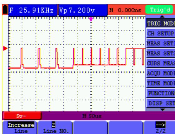
Рисунок 47. Запуск по синхроимпульсу заданной строки видеосигнала (экран 2)
