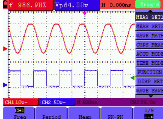
Рисунок 54. Автоматические измерения
