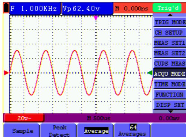
Рисунок 12. Режим усреднения осцилограмм
