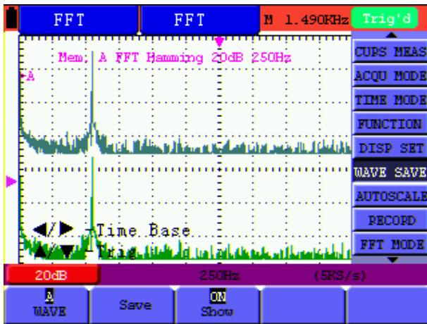
Рисунок 53. Сохранение осцилограммы в режиме БПФ
