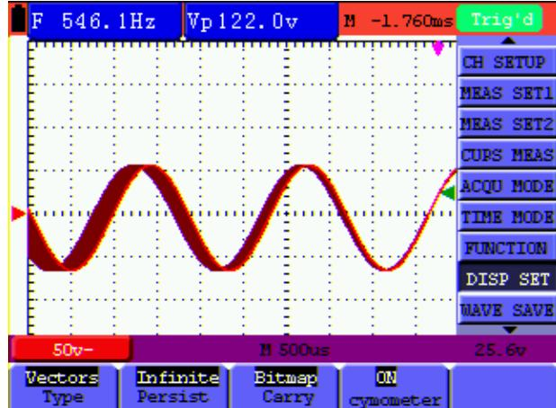
Рисунок 13. Функция послесвечения для наблюдения динамических сигналов
