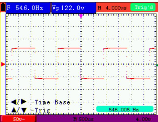
Рисунок 50. Отображение осцилограммы в растровом формате
