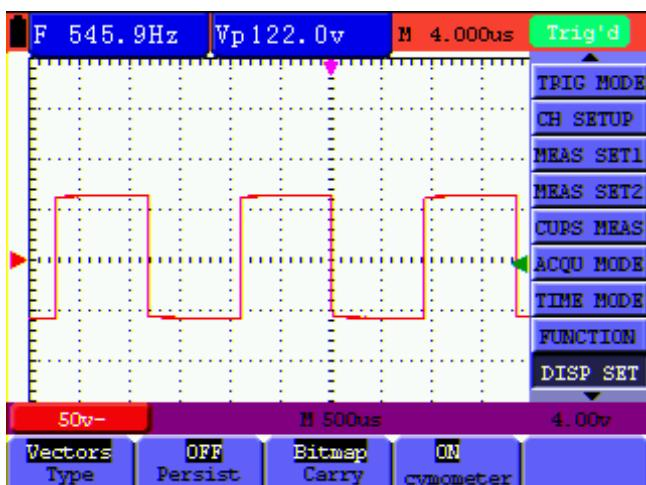
Рисунок 49. Отображение осцилограммы в векторном формате
