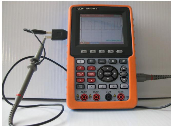
Рисунок 3. Подсоединение тестового прямоугольного сигнала
