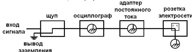
Схема заземления осциллографа в случае, когда осциллограф с питанием от батареи, подключен через соответствующий порт к компьютеру, работающему от электросети переменного тока:
