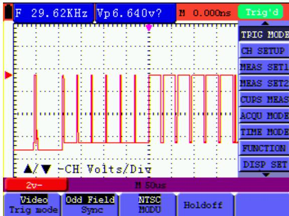
Рисунок 45. Запуск по нечетному кадровому синхроимпульсу видеосигнала
