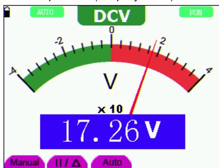
Рисунок 31. Измерение постоянного напряжения
