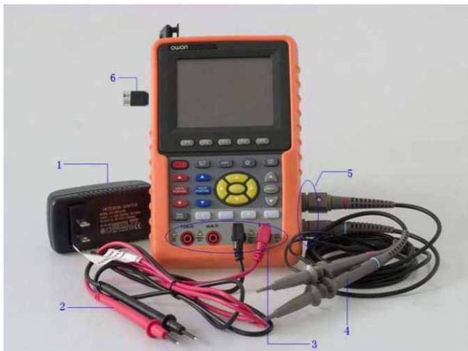
Рисунок 2. Входные разъемы и устройства
