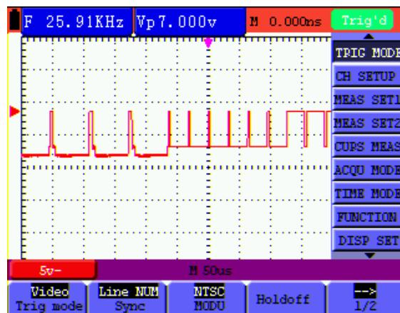
Рисунок 46. Запуск по синхроимпульсу заданной строки видеосигнала (экран 1)
