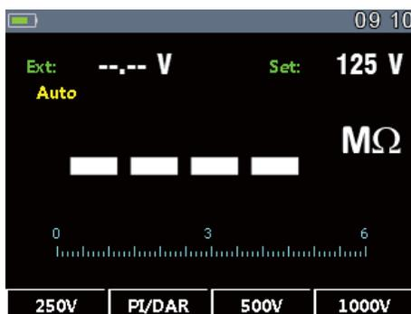
**Примечание.** Проверку изоляции можно проводить только в цепи с отключенным питанием (напряжением), измеряя индекс поляризации или коэффициент абсорбции.
