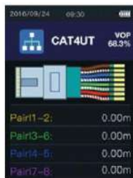
Измерение сетевого кабеля
