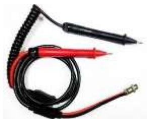
4-х контактный измерительный зонд
