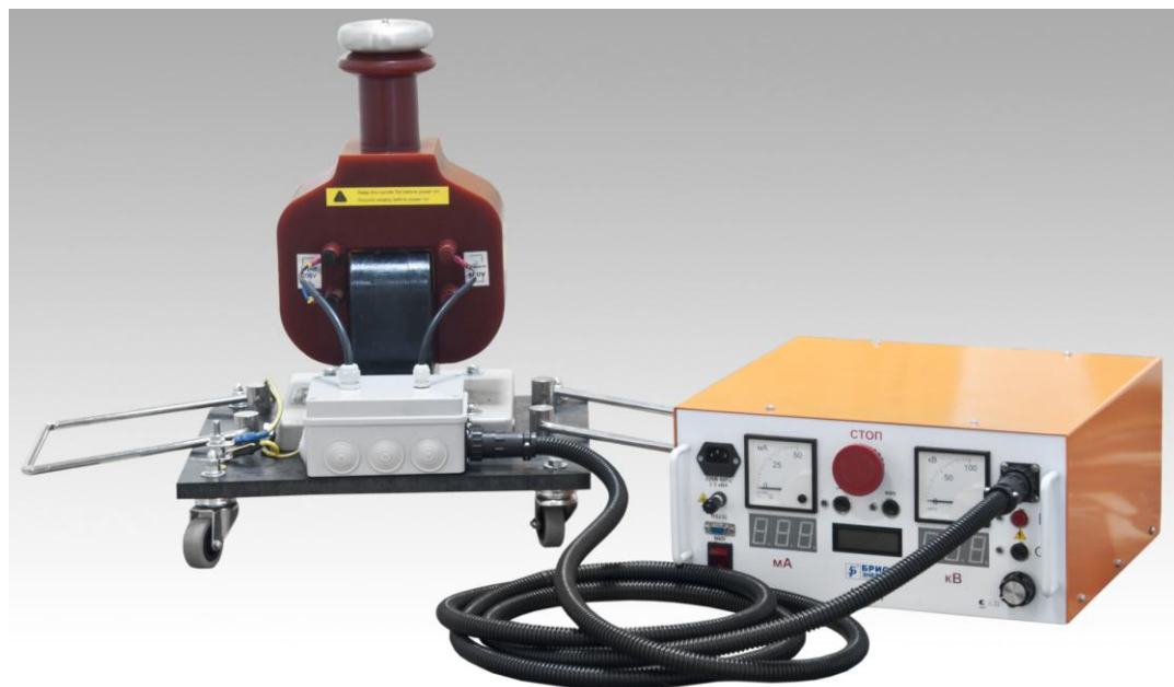
Рис.3. Испытания на переменном напряжении. Пульт для наглядности расположен рядом с высоковольтным трансформатором, при реальных испытаниях он должен быть разнесен на расстояние не менее 2.5м
