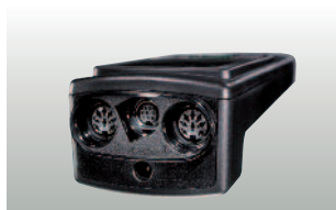
Разъемы для подключения зондов температуры, т/п Тип К/J/S и NTC, и комбинированного зонда влажности/температуры или зонда температуры Pt 100
