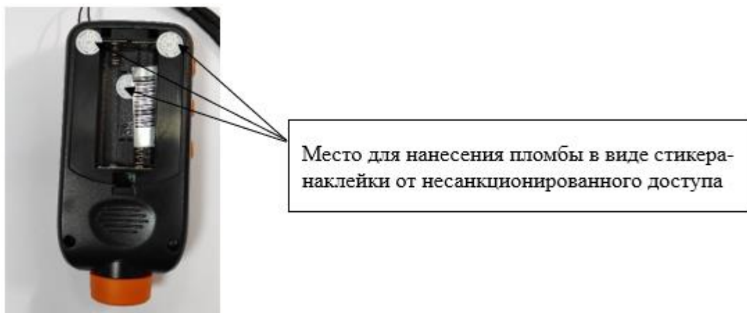
Рисунок 3 – Схема пломбировки от несанкционированного доступа
