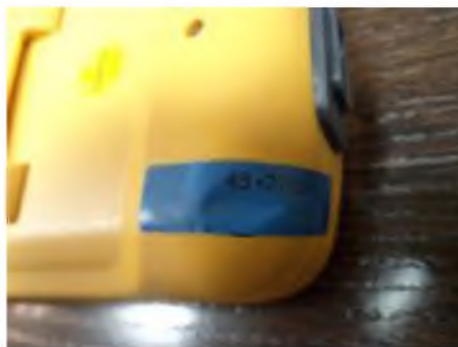
Рисунок 2. Фотография пломбирования мультиметров цифровых серии VA1
