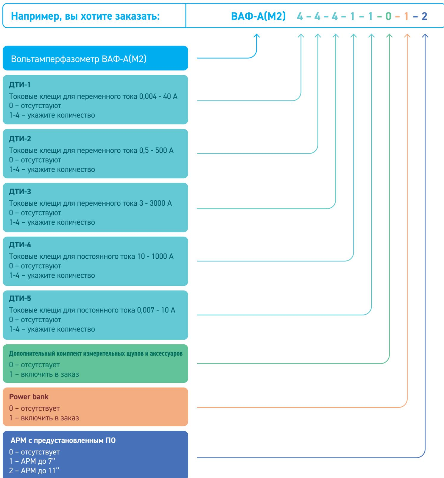
Пример записи при заказе: прибор вольтамперфазометр ВАФ-А(М2), с 4-мя ДТИ-1, 4-мя ДТИ-2, 4-мя ДТИ-3, одним ДТИ-4, одним ДТИ-5, без дополнительного комплекта измерительных щупов и аксессуаров, в комплекте с Power bank\*, АРМ\* до 11".
