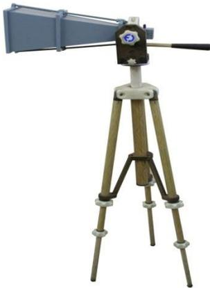
**Фото 1.** Антенна П6-125 на диэлектрическом штативе ШАД-01
