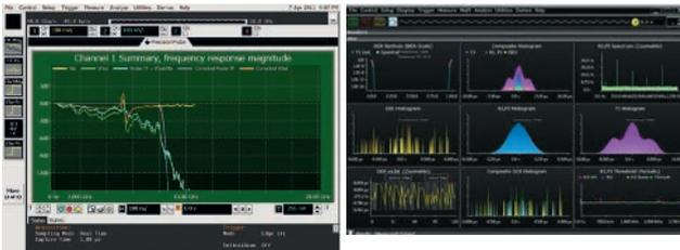
Используйте приложение PrecisionProbe для полного определения параметра S21 кабелей в диапазоне частот до 65 ГГц в дополнение к измерениям спектра и сложных форматов модуляции. Простой анализ цепей позволяет сэкономить время и повысить точность измерений за счёт автоматической компенсации потерь амплитуды и фазы в кабелях.
