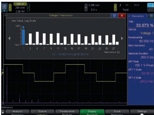
Выполняйте анализ гармоник напряжения или тока до 250-ого порядка. Форма колебаний сигнала во временной области (желтая линия) и таблица гармоник отображаются одновременно. Кроме таблицы может одновременно отображаться гистограмма порядков гармоник для визуального определения гармоник высоких значений.
