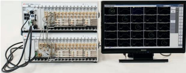
ВАЦ в формате PXIe M9485A специально создан для применения в условиях крупносерийного производства интерфейсных модулей, коммутаторов и фильтров, применяемых в мобильных телефонах и базовых станциях сотовой связи. Многопортовая архитектура устройства обеспечивает наивысшую в своём классе скорость измерений – в среднем до 30 процентов выше, чем у других сравнимых по параметрам приборов, сохраняя при этом широкий динамический диапазон.
