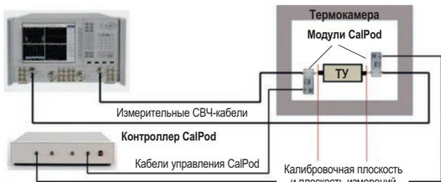
Модули CalPods при работе с анализаторами PNA могут устранить уход параметров измерительных кабелей. Калибровочная плоскость находится в плоскости подключения модулей CalPod к тестируемому устройству (ТУ).
