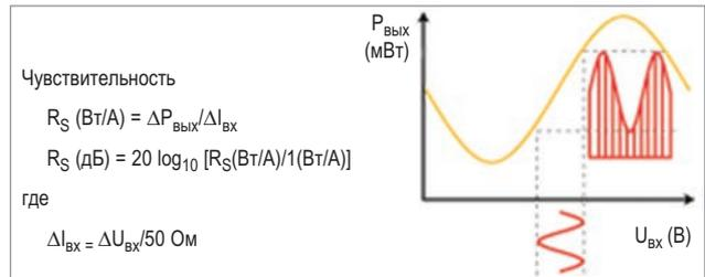
Рисунок 3 - Передаточная характеристика Э/О преобразователей (внешних модуляторов)
