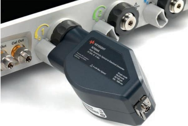
Оптоэлектронный преобразователь N7004A компании Keysight - высокочувствительный фотоприёмный модуль, предназначенный для прямого оптоэлектронного преобразования оптических сигналов связи или передачи данных на входе осциллографа реального времени Infiniium с интерфейсом AutoProbe II.
