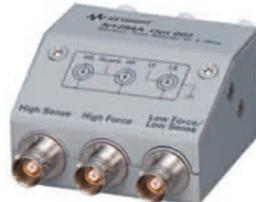
Переход преобразует 6 выходов с однополюсными гнездами для вилки с пружинящими боковыми накладками (типа "банан") в 3 выхода с триаксиальными соединителями. Он доступен для B2901A/02A/11A/12A и B2961A/62A.
