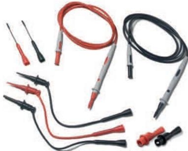
Комплект измерительных щупов U8202A включает два измерительных провода и пробники, зажимы "крокодил", зажимы для подключения к ИС с выводами для монтажа на поверхность, измерительных пробники с тонкими наконечниками. Измерительные провода и пробники соответствуют CAT III 1000 В, 15 А.
