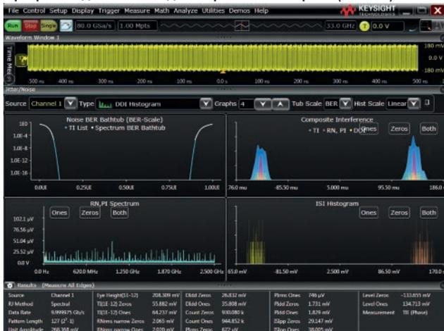
Эта программа декомпозиции шума обеспечивает статистический анализ сигналов высокоскоростных цифровых интерфейсов в вертикальной (амплитудной) области. Она является дополняющей по отношению к программе декомпозиции джиттера EZJIT Plus (N5400B), которая в течение многих лет обеспечивала точный анализ сигналов в горизонтальной (временной) области.
