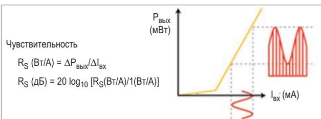
Рисунок 2 - Передаточная характеристика Э/О преобразователей (лазеров и светодиодов)
