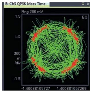
Сигнал QPSK с эмулируемым фазовым шумом
