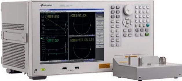
Анализатор импеданса E4991B компании Keysight имеет диапазон частот от 1 МГц до 3 ГГц. E4991B обеспечивает основную погрешность измерений  $0,65\%$  в широком диапазоне значений импеданса с использованием встроенного источника смещения по постоянному току до 40 В (опция 001). Функция анализа эквивалентных схем поддерживает семь различных многопараметрических моделей и позволяет моделировать собственные значения эквивалентных параметров компонентов.
