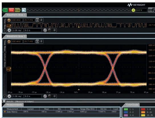
Встроенная прецизионная система восстановления тактового сигнала общего назначения на основе ФАПЧ позволяет определять характеристики даже патентованных последовательных шин частных компаний.
