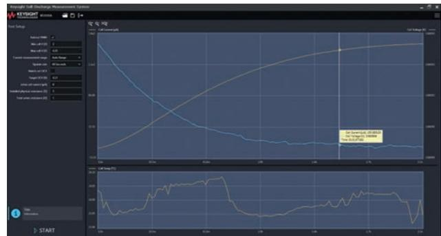
Результат теста на BT2191A для "нехорошей" батареи. 1-канальная система измерила стабильный ток саморазряда в 150 мкА за ~2 часа.
