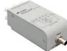
Переход с функцией фильтра, обеспечивающим сверхнизкий уровень шумов, преобразует 6 выходов с однополюсными гнездами для вилки с пружинящими боковыми накладками (типа "банан") в 1 выход с соединителем BNC. Он может использоваться с B2961A/62A.
