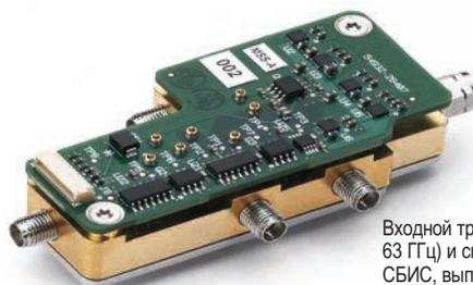
Входной тракт канала (50, 59 или 63 ГГц) и специализированная СБИС, выполненные по эксклюзивной технологии RealEdge
