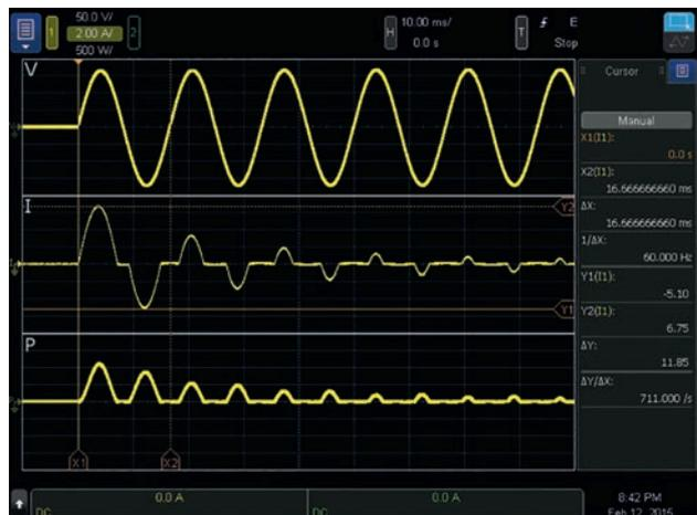
Используйте курсоры для выполнения обычных измерений, как показано на правой панели экрана. Здесь анализатор мощности Keysight IntegraVision отображает пусковой ток (средний график) и мощность (нижний график), возникающие после включения входного напряжения линии переменного тока (верхний график). Курсоры показывают пик 6,75 А во время первого цикла.
