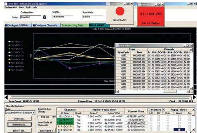
Программа BenchLink Data Logger 3, работающая в среде Windows®, использует знакомую пользователю среду электронных таблиц для указания данных измерения, которые должны быть собраны.
