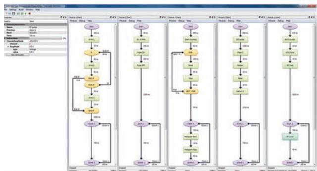
Дружелюбная среда программирования аппаратных виртуальных приборов (HVI) M3601A компании Keysight с представлением последовательности операций в виде блок-схем.
