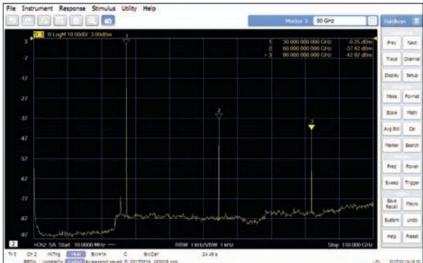
Приложение многоканального анализатора спектра PNA используется для измерения гармоник усилителя миллиметрового диапазона.
