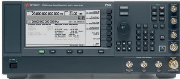
Генератор сигналов НГ E8257D предназначен для использования в качестве источника гетеродина или испытаний компонентов
