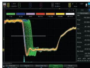
Градация по цвету показывает, как часто появляется сигнал. После обнаружения проблемы при скорости обновления сигналов до 450 000 осциллограмм/с выделите проблемные сигналы, используя запуск InfiniiScan Zone.
