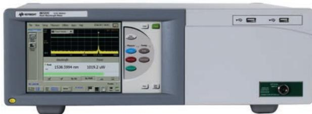
Каждая модель семейства измерителей длины волны компании Keysight использует совместимые команды дистанционного управления языка SCPI. Если в будущем потребуется более производительный прибор, можно заменить измеритель длины волны другим прибором компании Keysight без лишних затрат средств и времени на разработку нового кода для испытательной системы. Измеритель 86122C можно модернизировать, чтобы получить более высокий уровень характеристик.
