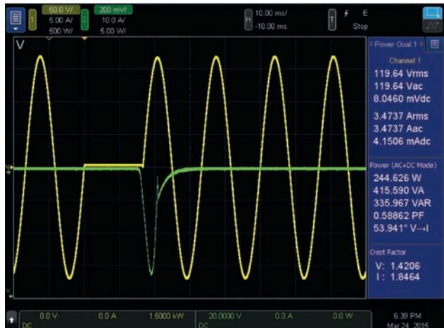
Выберите одну из 8 разных структур экрана отображения формы колебаний напряжения, тока и мощности. Здесь анализатор мощности IntegraVision показывает увеличенное изображение напряжения и тока на одинаковой сетке, чтобы выделить временную связь между напряжением и током.
