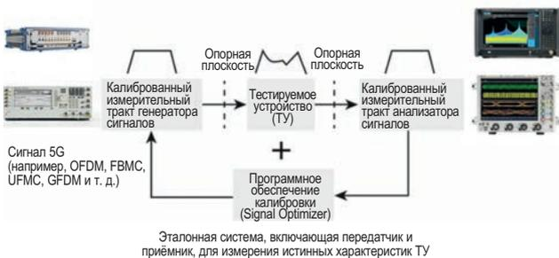
Калиброванная измерительная система, включающая передатчик и приёмник, для измерения истинных характеристик ТУ.
