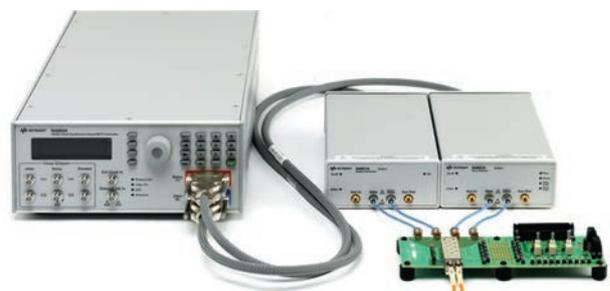
Тестирование приёмопередатчиков сетей 16x Fibre Channel (16 GFC)
