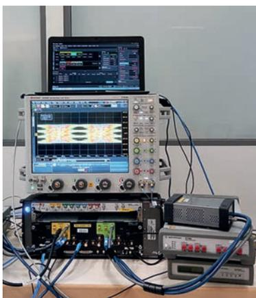
На фотографии в качестве примера показана измерительная система, включающая необходимые аппаратные средства: одну из моделей осциллографов, упомянутых выше, модуль генератора кодовых последовательностей M8045A из состава измерительных приборов серии M8040A и кабельные принадлежности. Дифференциальные выходы канала 1 модуля M8045A подключены к входным трактам каналов осциллографа DSAZ634A через выносную головку M8057A.
