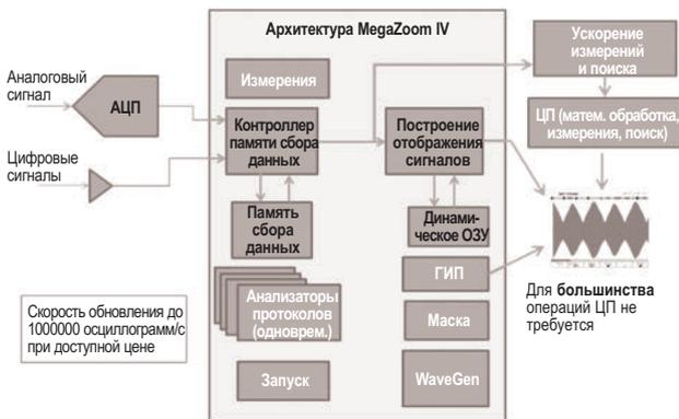
Шесть блоков с текстом белого цвета на рисунке теперь полностью интегрированы в одну СБИС. Это позволило значительно улучшить все основные технические характеристики, повысить скорость измерений с сохранением оптимальных рабочих диапазонов и производительности при более глубоких возможностях анализа сигналов. Включение большинства функций осциллографа в состав одной СБИС улучшило характеристики прибора при одновременном снижении цены.
