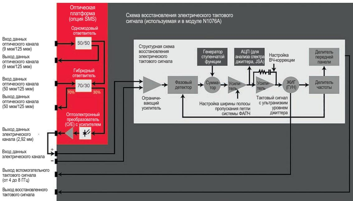
На рисунке на светлом фоне представлена структурная схема модуля восстановления электрического тактового сигнала N1076A. Он восстанавливает тактовые сигналы из входных сигналов с кодированием NRZ и PAM-4 и обеспечивает возможность анализа джиттера (опция JSA)
