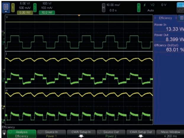
Значения напряжения, тока и мощности отображаются одновременно в режиме реального времени, причем каждый параметр имеет собственную сетку (структура экрана, принятая по умолчанию). Структура экрана и функции аналогичны обычному осциллографу.
