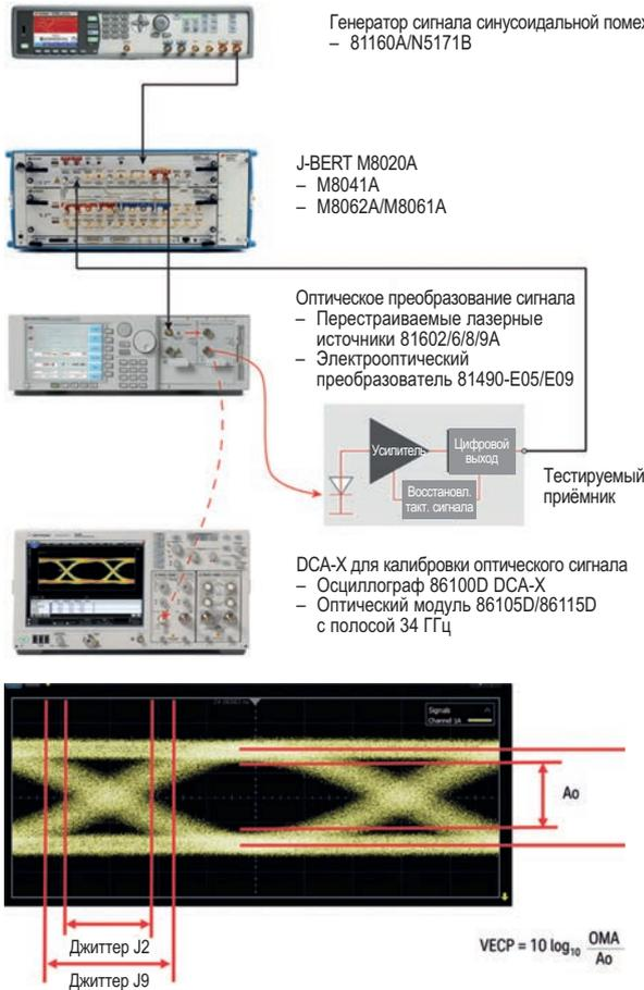
Определение параметров оптического сигнала со стрессовым воздействием
