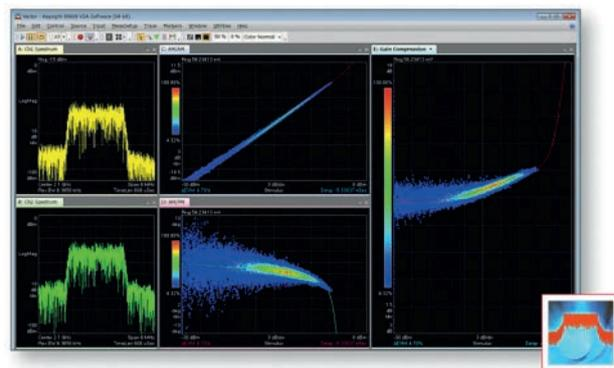
Программа векторного анализа сигналов 89601B расширяет возможности осциллографов InfiniiVision и Infiniium. Эта программа, в основе которой заложена цифровая обработка сигналов, использует данные сигнала, преобразованные осциллографом в цифровую форму, и выполняет анализ спектра на базе БПФ, а также анализ широкополосной цифровой модуляции.
