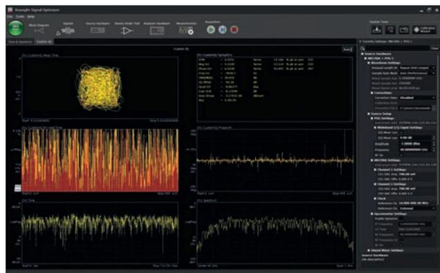
Измеренное значение EVM до коррекции для сигнала с модуляцией 64-QAM (ширина полосы частот модуляции 1 ГГц, одна несущая, центральная частота 40 ГГц) равно 6%.
