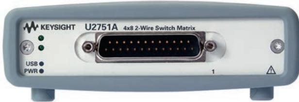
Коммутационная матрица с шиной USB U2751A предлагает высококачественное и недорогое техническое решение для автоматизированных испытаний. Она имеет 32 двухпроводных элемента коммутации, организованных в виде конфигурации из четырёх строк и восьми столбцов (4x8), позволяя соединение с любой комбинацией строк и столбцов, в том числе с несколькими каналами одновременно. U2751A включает также счётчик циклов срабатывания реле.
