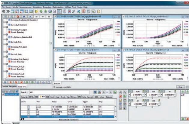
Программа построения моделей Model Builder Program (MBP) представляет собой универсальное решение, которое обеспечивает автоматизацию измерений и гибкость для моделирования устройств на основе кремния. MBP включает мощные встроенные методы параметризации и моделирования, а также открытый интерфейс для настройки и управлением всем процессом моделирования.
