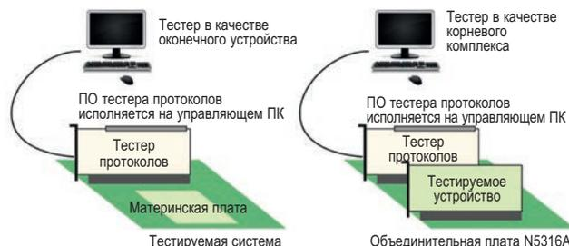
Тестер PCIe U4305B в качестве оконечного устройства и корневого комплекса
