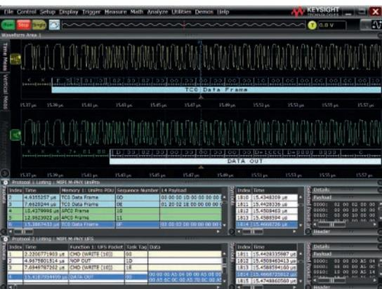
Пример декодирования двух протоколов одновременно.
