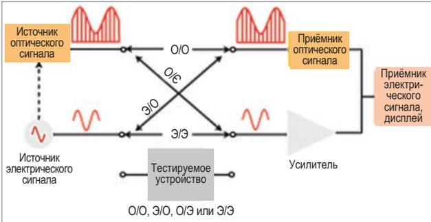
Рисунок 1 - Структурная схема анализатора оптических компонентов
