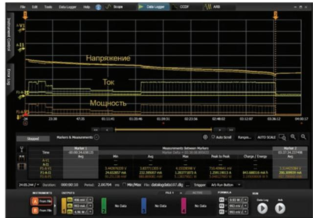
N6705C может также использоваться с программой управления и анализа 14585A, которая обеспечивает дополнительные функции управления и анализа.
