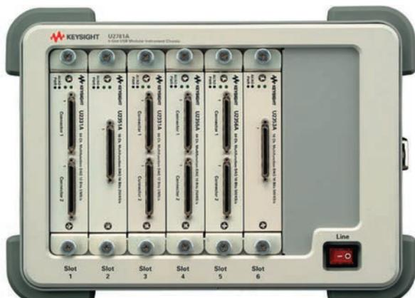
Шасси модульных приборов U2781A с размерами 250 мм (ширина), 177 мм (высота) и 271 мм (глубина) имеет шесть слотов для установки модулей серий U2300A, U2500A и U2600A, а также модульных измерительных приборов U2701A/U2702A, U2722A/U2723A, U2741A, U2751A, U2761A.
