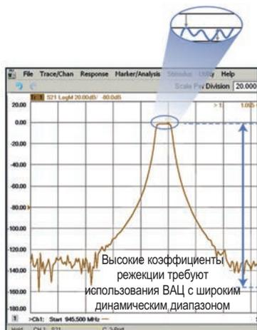
Точные измерения низких вносимых потерь и низкой неравномерности АЧХ требуют использования ВАЦ с низким уровнем шума трассы графика и высокой стабильностью характеристик.
