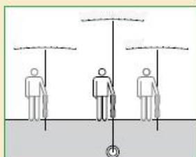
**Назначение:** Точное определение местоположения линии до и во время выемки грунта. Большинство профессионалов обучены этому режиму работы и признательны за простоту изображения на дисплее.
