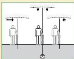
**Назначение:** Контроль общего направления линий как часть предварительного сканирования при локализации линии. Лучший режим для зон с высокой плотностью линий, чем только один нулевой режим.
