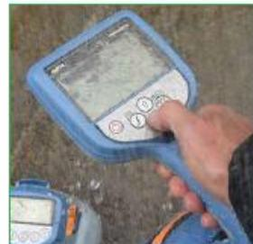
**Предназначен для эксплуатации непосредственно на месте проведения работ – IP65**
