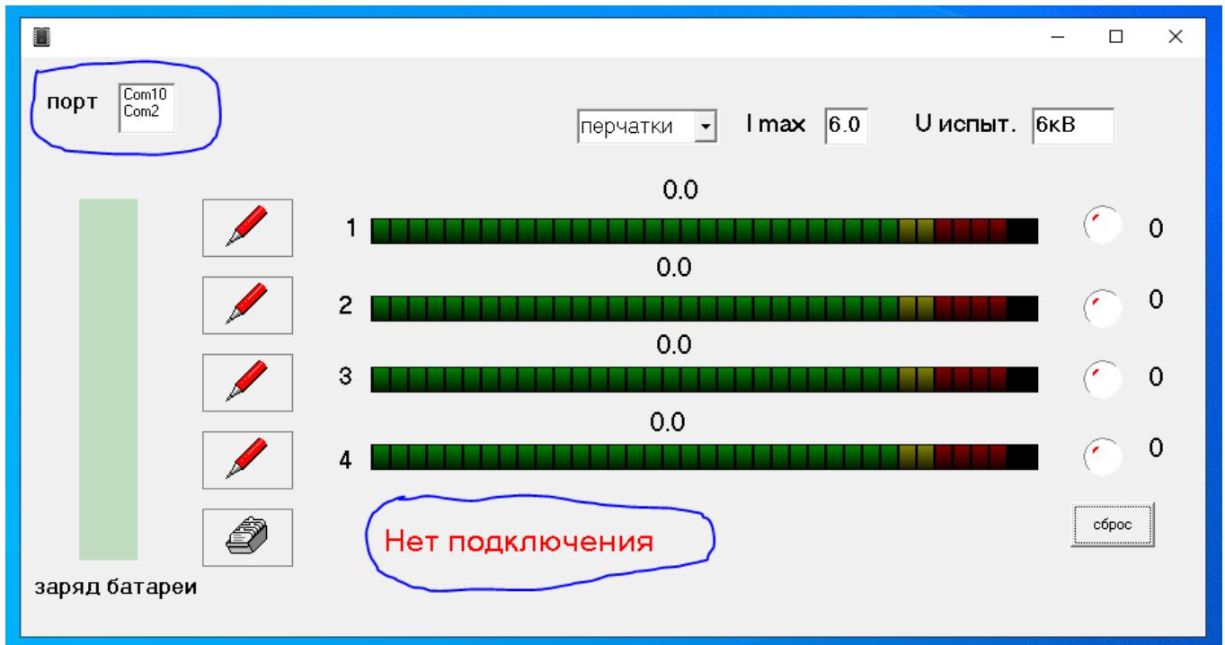
Сейчас компьютер имеет 2 сом порта-сом2 и сом10. Надо подключиться к сом10, диспетчер устройств определил, что беспроводной адаптер подключен к этому порту. Выбираем сом10 и видим следующую картину.
