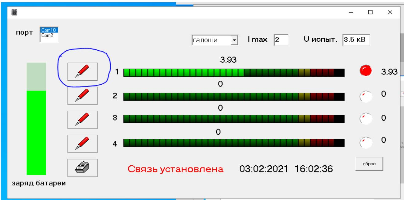
Ток утечки – реальный ток утечки в процессе испытаний. Если он меньше допустимого, делается отметка «годен».
