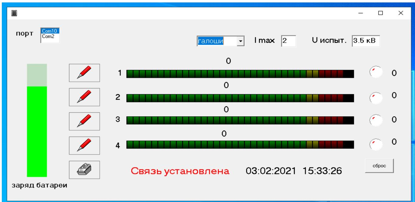
В соседнем окошке появилось значение максимально допустимого тока для галош – 2 мА. Если ток при испытании превысит этот порог, загорится красная лампочка-индикатор. Значение порога можно изменять в пределах 1 - 7.5 мА. Испытательное напряжение носит чисто справочный характер.
