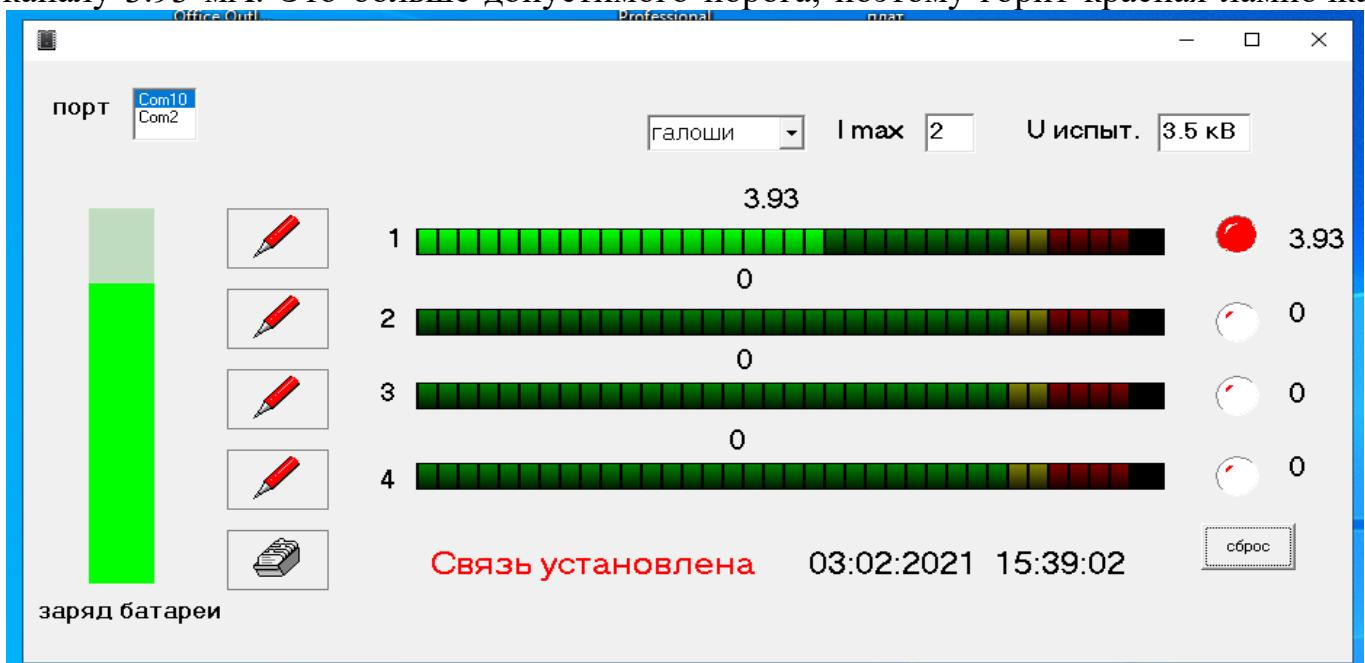
Она останется гореть, даже если выключить испытательное напряжение. Чтобы ее погасить, надо нажать кнопку сброс.
