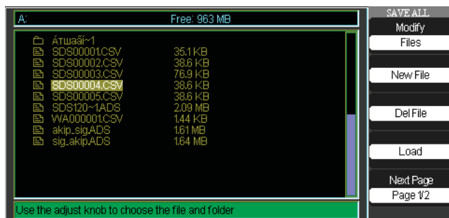
Рисунок 2-50 Меню интерфейса файловой системы SAVE ALL
