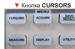
Рисунок 2-40 Кнопка вызова меню курсорных измерений
