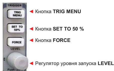
Рисунок 2-20 Органы управления системы запуска
