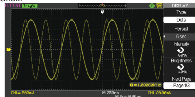
Рисунок 2-39 Выбор длительности послесвечения
