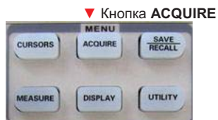
Рисунок 2-30 Кнопка вызова меню системы регистрации сигналов
