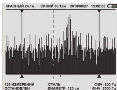
На таком графике уже можно определить место утечки.
