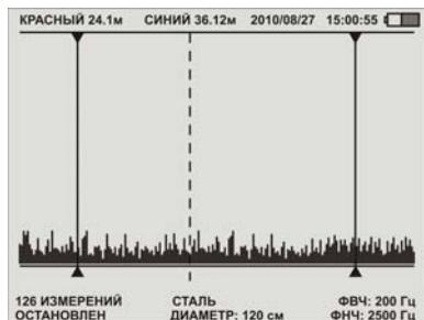
При получении такой корреляционной функции убедитесь в «ФИЛЬТР» что сигналы от датчиков присутствуют.
