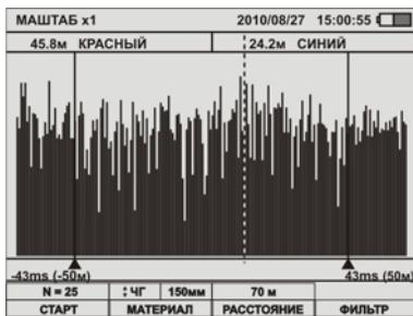
На рисунке показан график корреляционной функции «плохой» утечки.
