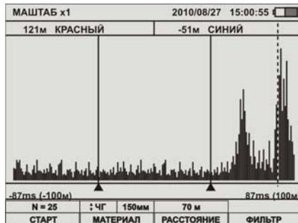
После проведения измерений за границами установки датчиков, установите датчики так чтобы утечка находилась между датчиками и повторите измерения.
