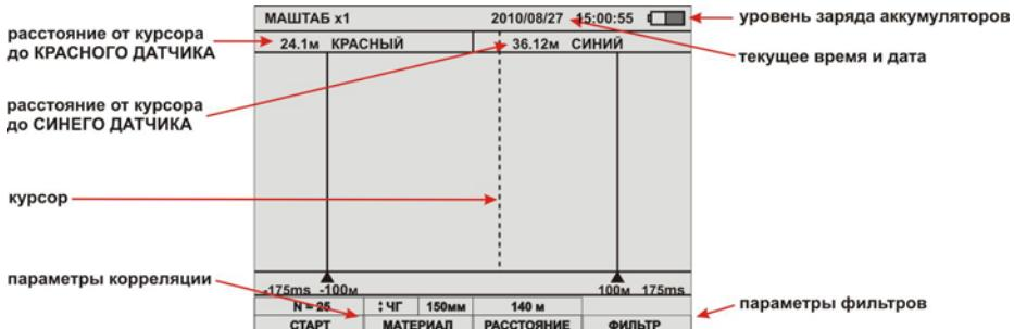
На дисплее отображается режим корреляции.
