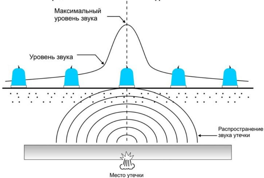
Основные частоты шумов утечек располагаются в диапазоне 300 - 500Гц. На полиэтиленовых трубопроводах, а также трубопроводах низкого давления могут возникать более низкочастотные шумы.
