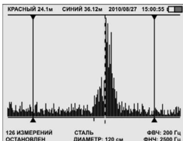
Прочтение данного графика не вызывает трудностей, т.к. место точечной утечки явно выражено. Шум утечки значительно превышает внешние шумы и шумы трубопровода. На графике отсутствуют отражения от препятствий на трубопроводе и шумы.
