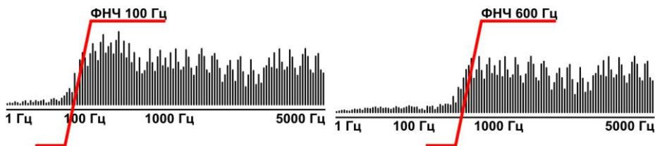
Нажав «F3», установите частоту среза высоких частот. Установите необходимую частоту среза высоких частот.
