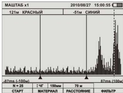
Теперь более подробно видна утечка. Для уточнения места утечки установите датчики так, чтобы утечка была между датчиками, и повторите измерения.
