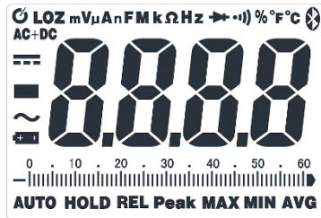
**HOLD** – Зафиксированный результат на экране.
