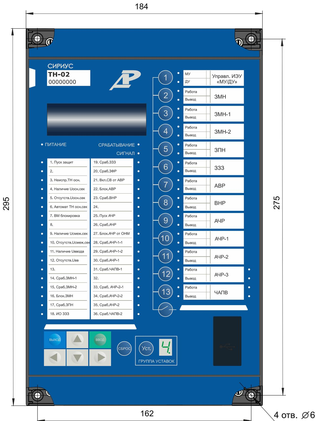
Рисунок А.1 – Вид спереди (панель типа LA41)
