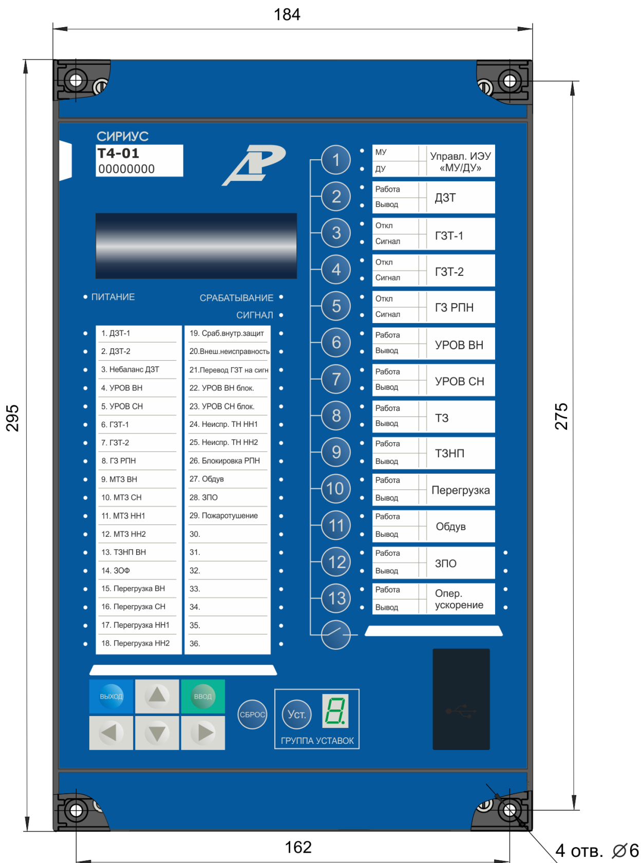
Рисунок А.1 – Вид спереди (лицевая панель LA41 для исполнений K407-41 и K450-41)
