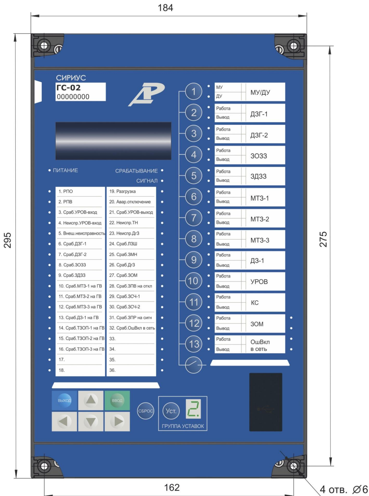
Рисунок А.1 – Вид спереди (панель типа LA41)
