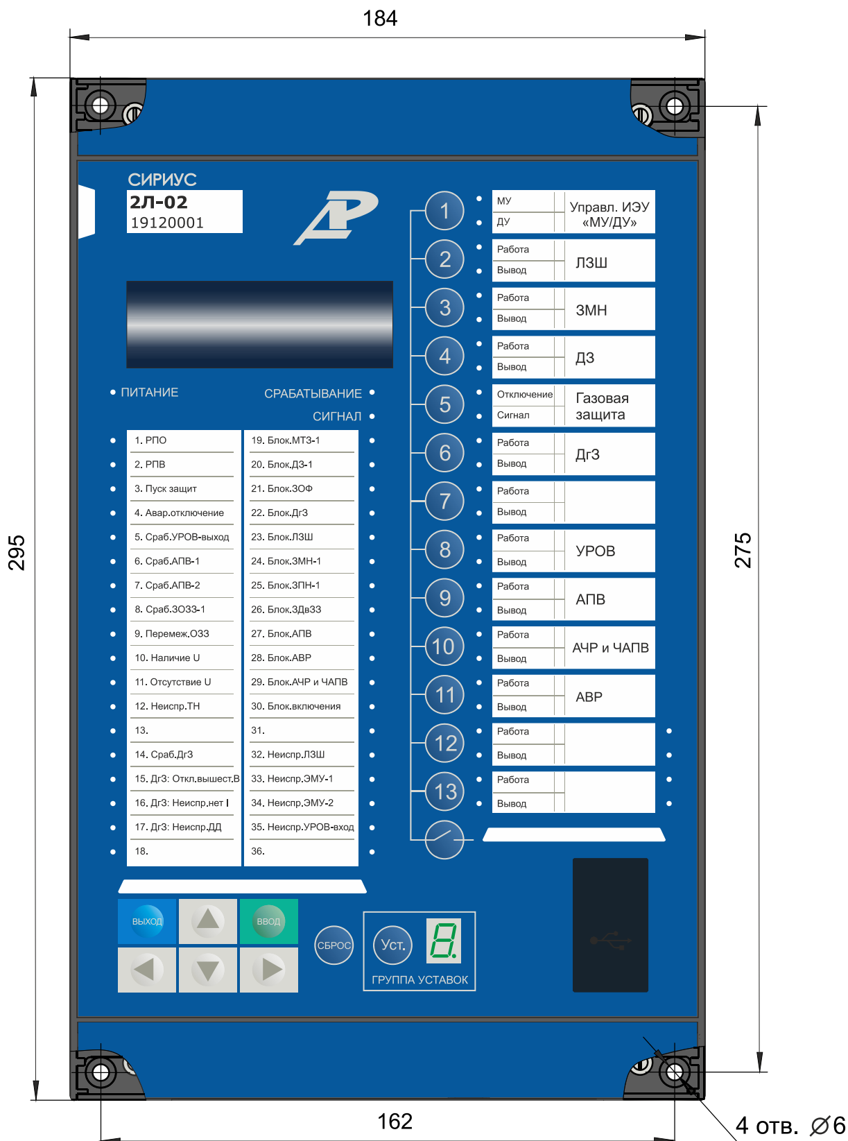
Рисунок А.1 – Вид спереди (лицевая панель LA41)
