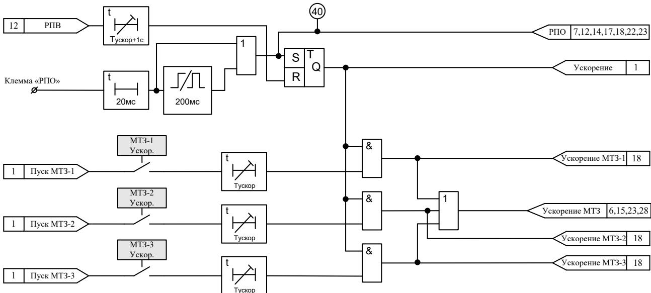
**Рисунок И.2 – Ускорение МТЗ**
