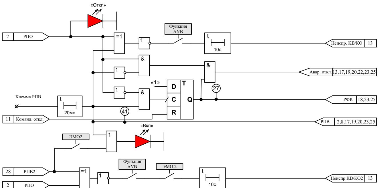
Рисунок И.12 – Формирование сигналов РФК, аварийного отключения и неисправности КВ/КО
