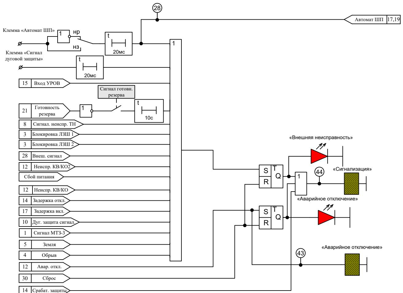
Рисунок И.13 – Аварийная и предупредительная сигнализация
