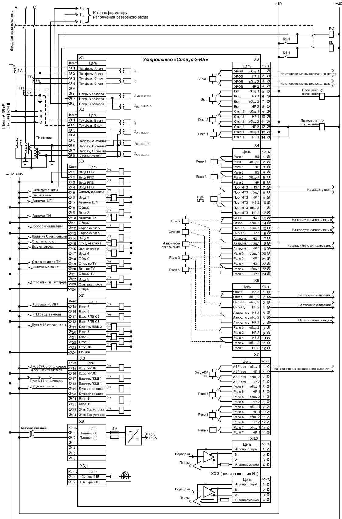
Рисунок Д.1 – Схемы подключения внешних цепей к устройству «Сириус-2-ВБ»
