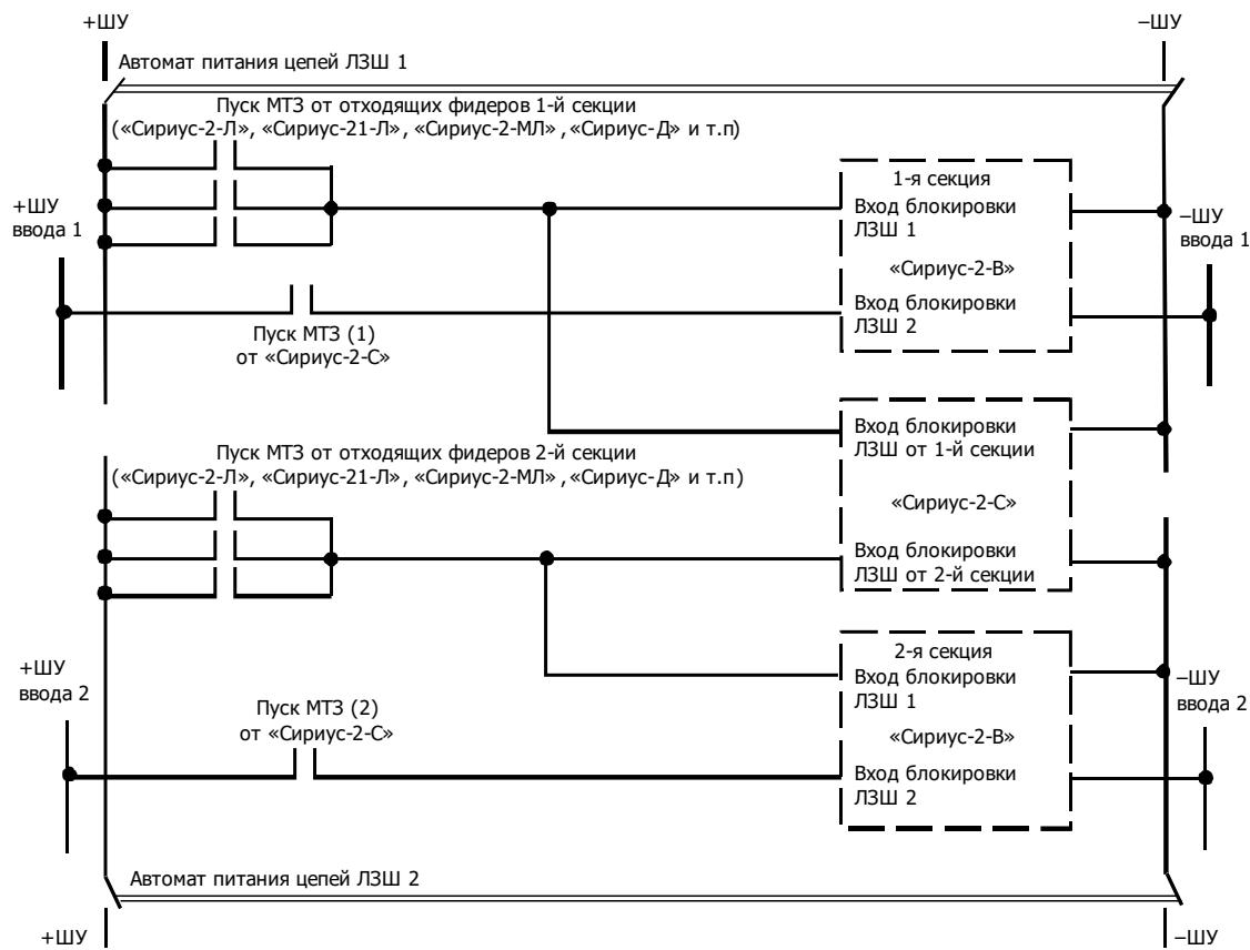
Рисунок Д.6 – Схема соединения нескольких устройств между собой при организации логической защиты шин (параллельная схема)
