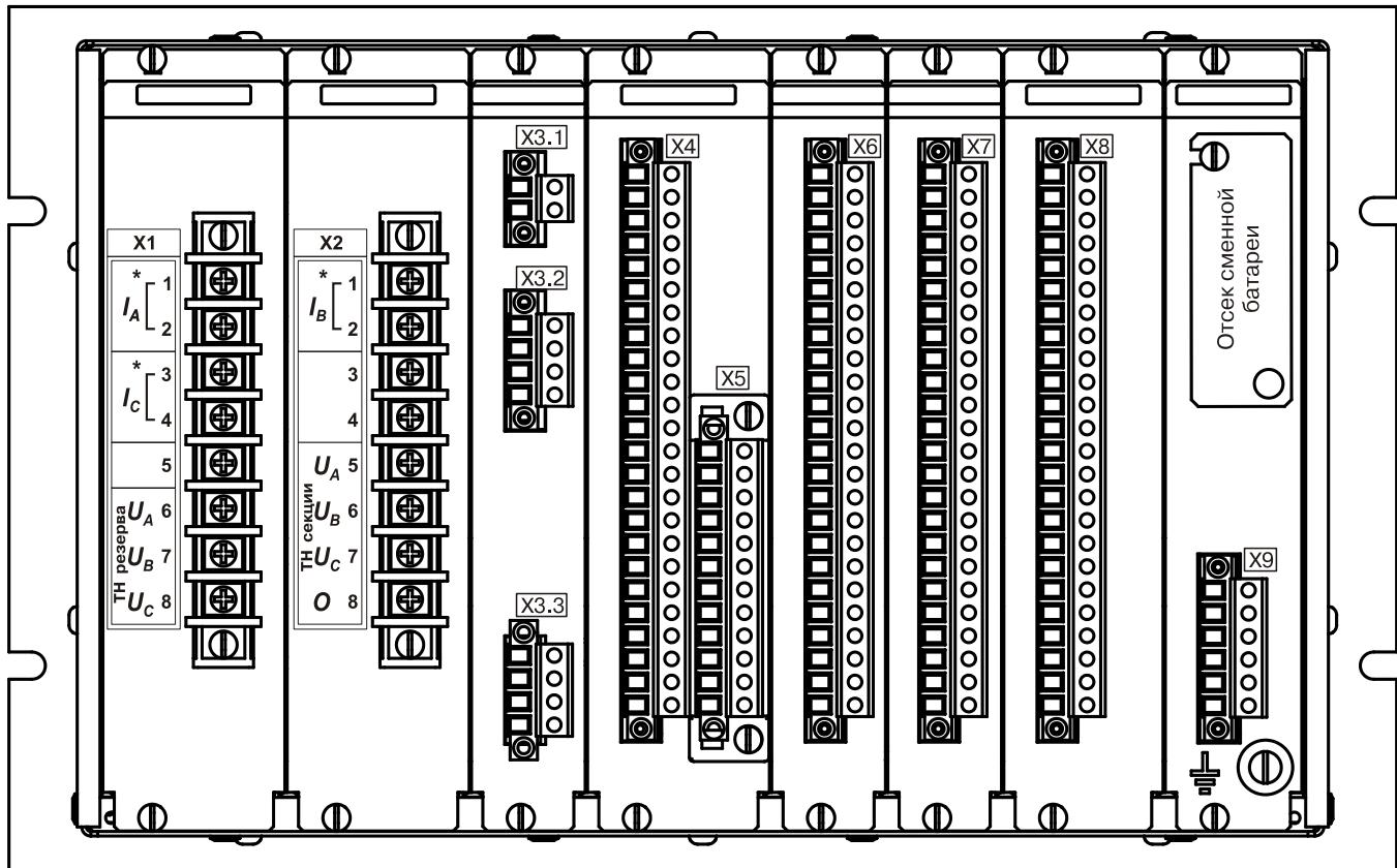
Рисунок Г.4 – Расположение элементов на задней панели устройства «Сириус-2-ВБ»
