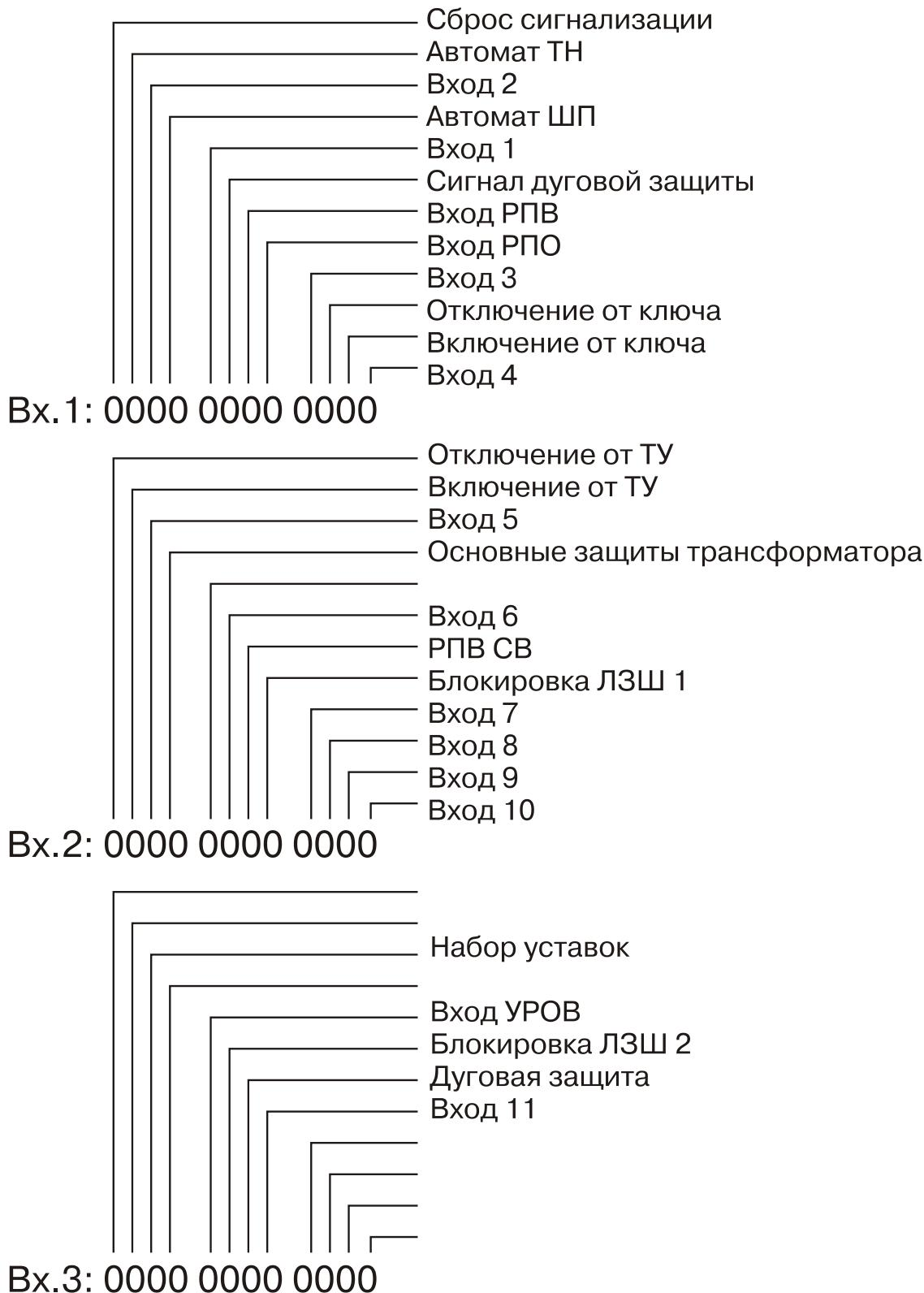
Рисунок В.1 – Соответствие входных дискретных сигналов в режиме «Контроль входов». Наличию сигнала на входе соответствует «1», отсутствию – «0».
