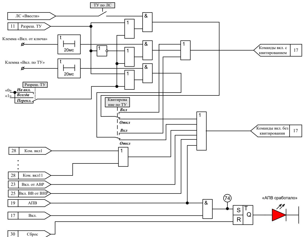
Рисунок И.16 – Автоматика управления выключателем – включение (начало)
