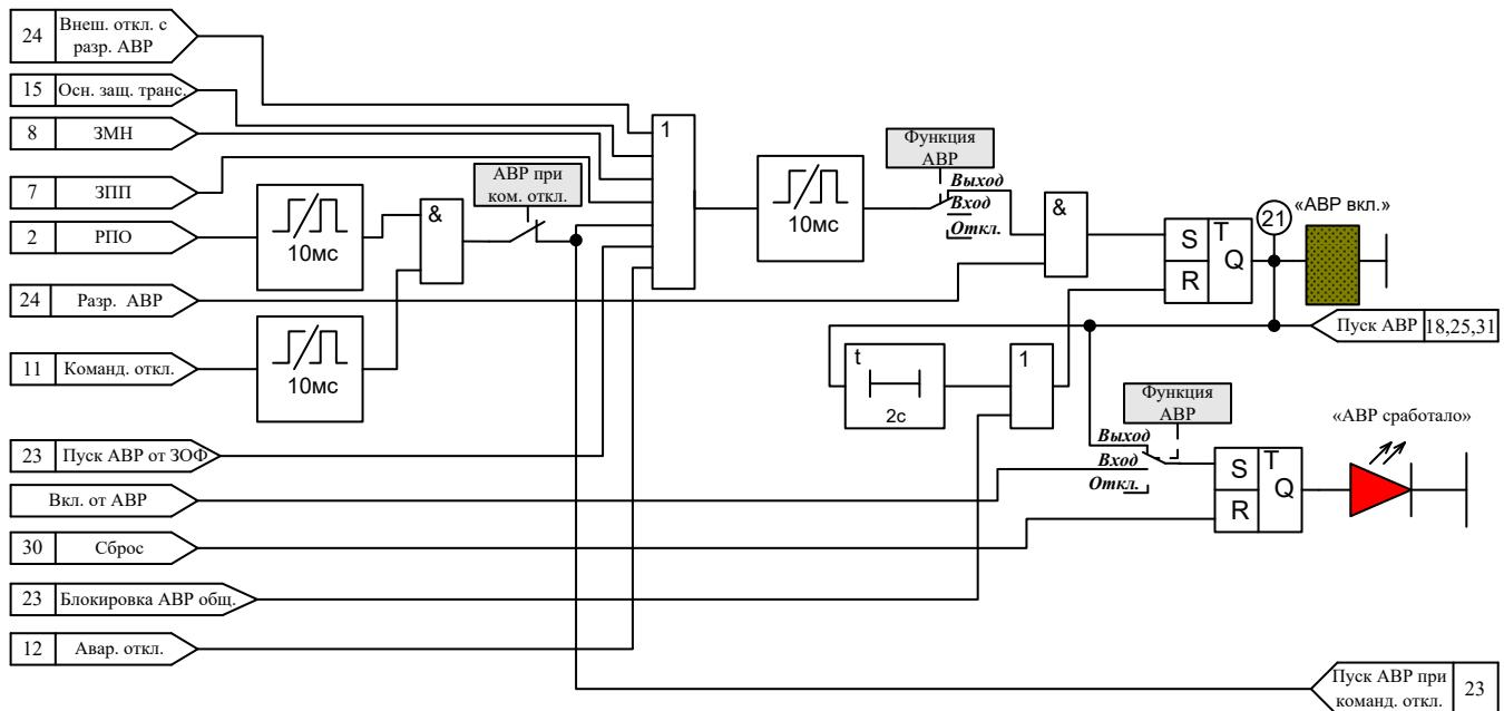
Рисунок И.22 – Автоматическое включение резерва (ABP) (начало)
