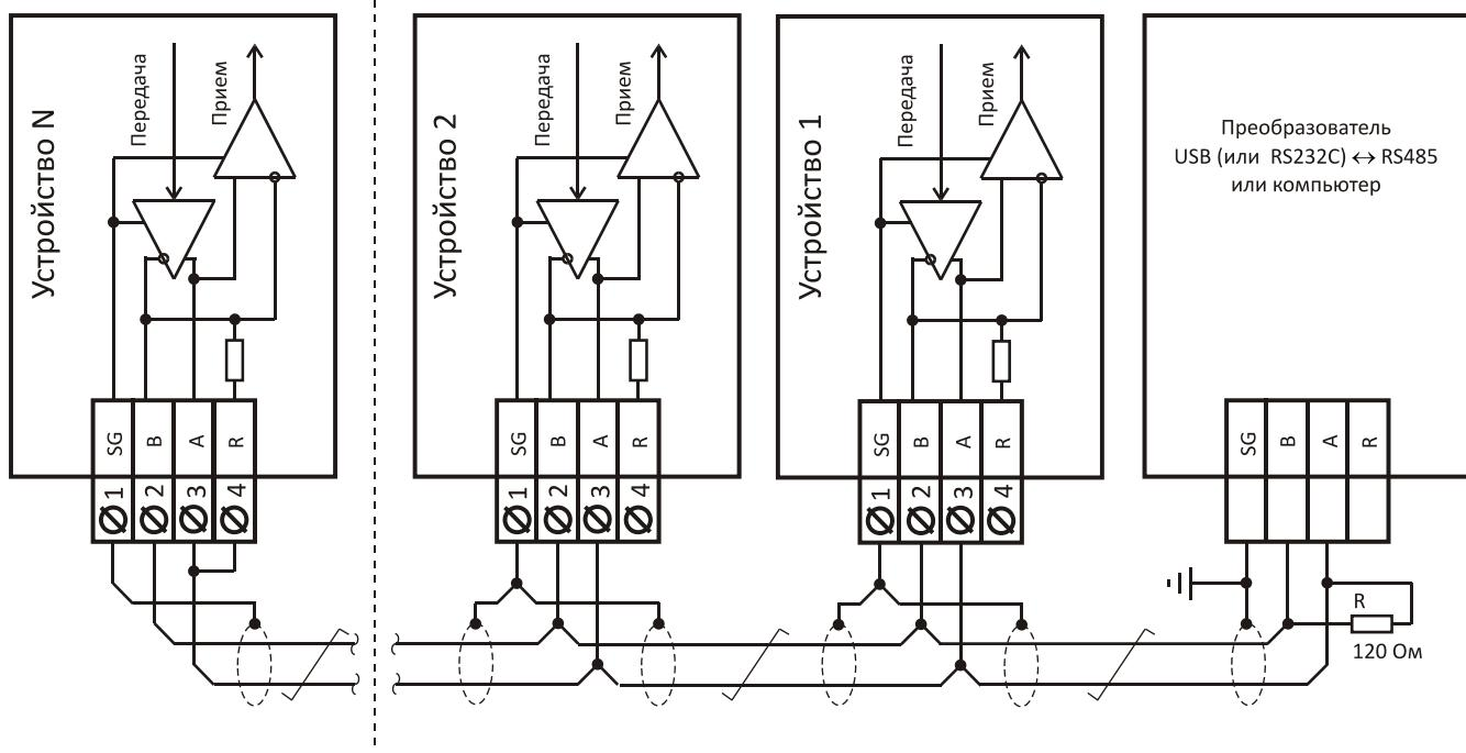
исунок Д.5 – Схема подключения устройств с интерфейсом RS485 в локальную сеть.
