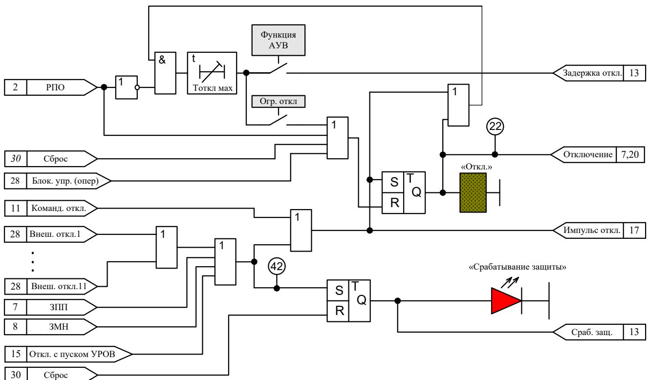
Рисунок И.14 – Автоматика управления выключателем – отключение
