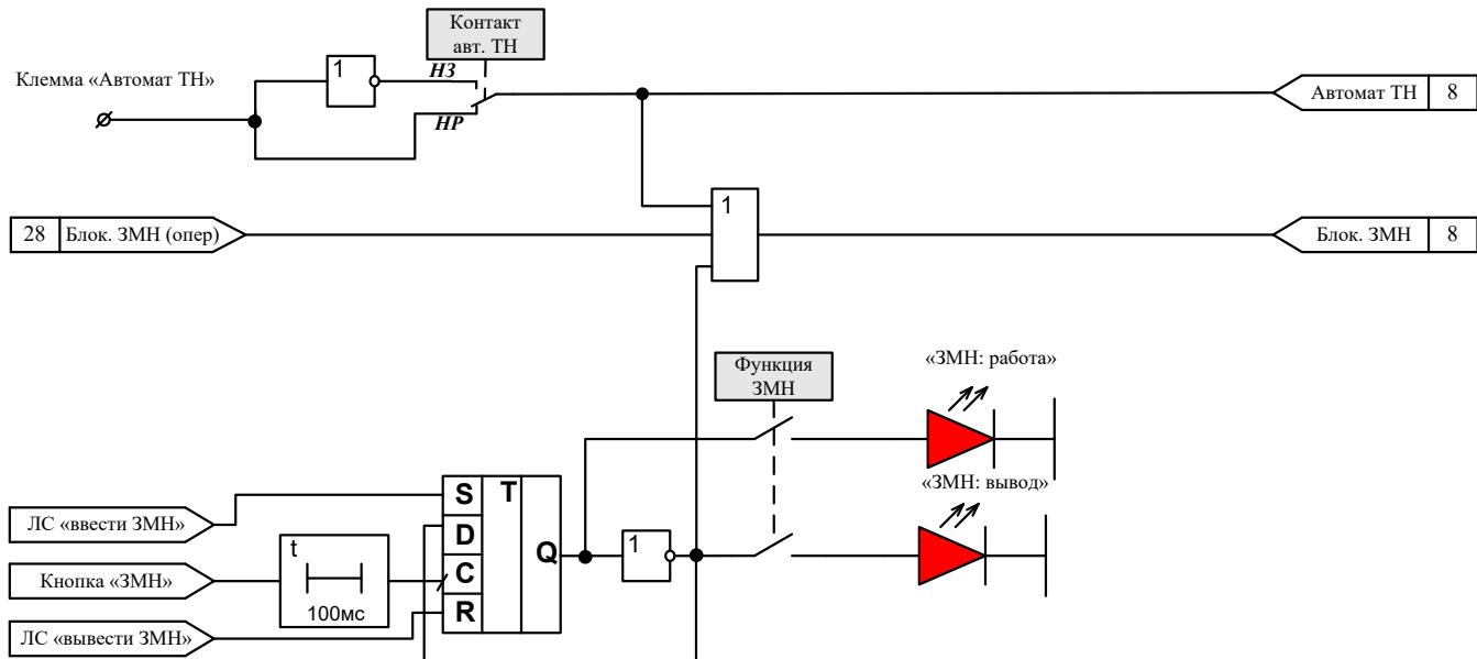
Рисунок И.9 – Защита минимального напряжения (ЗМН)
