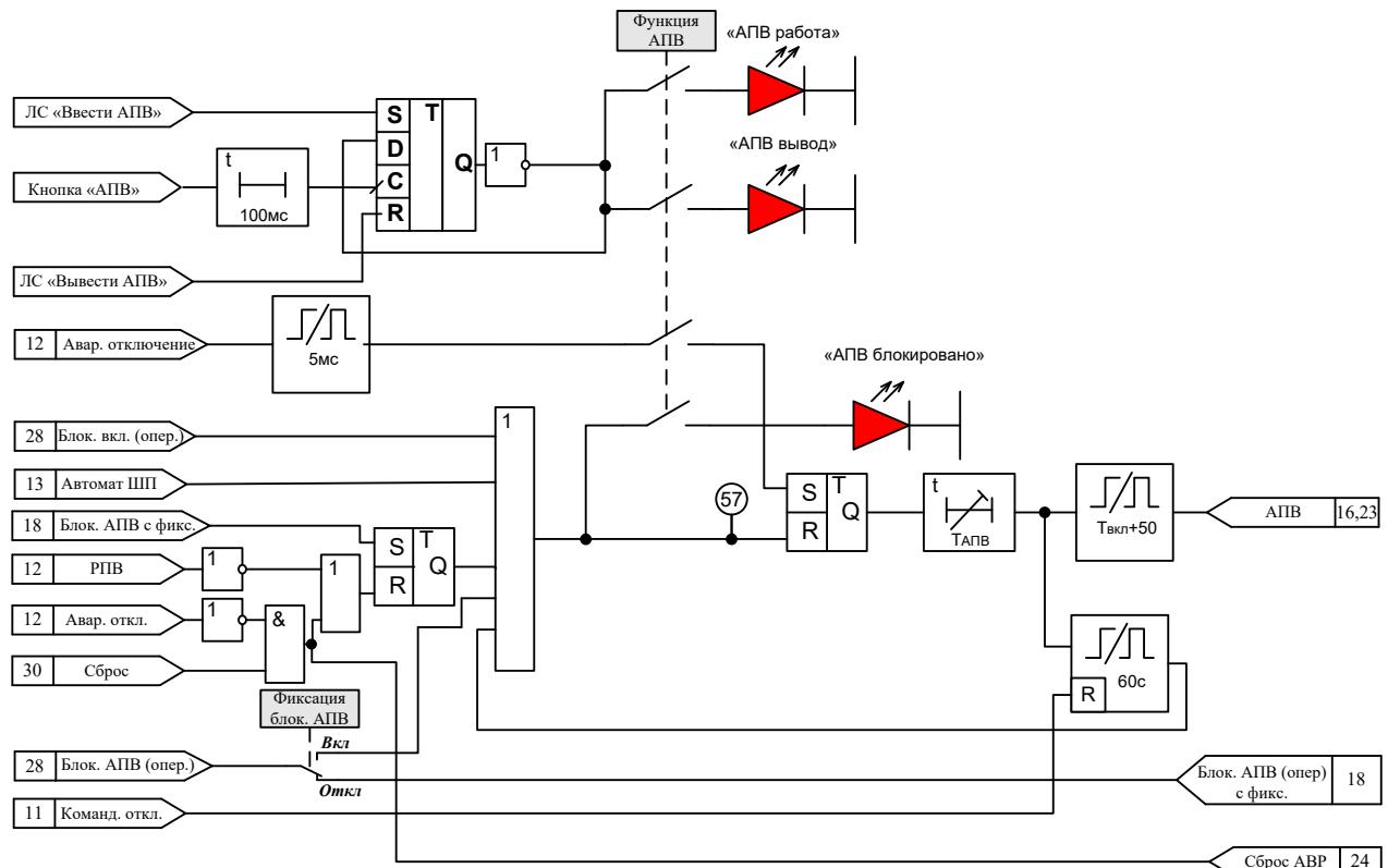
Рисунок И.19 – Автоматическое повторное включение (АПВ)
