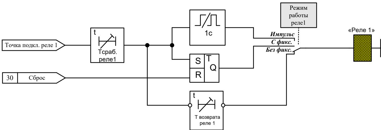
Рисунок И.26 – Программируемые реле
