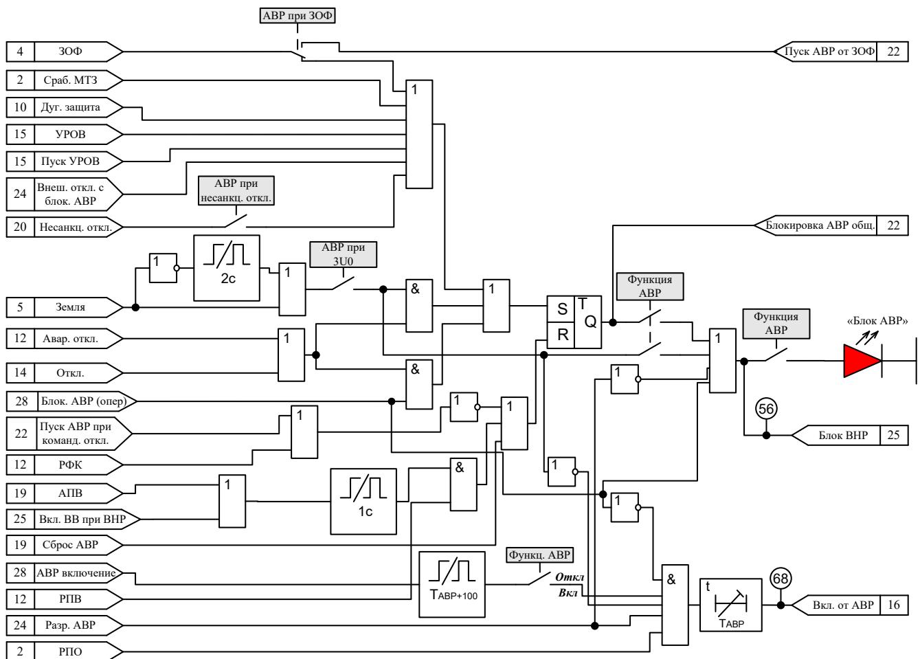
Рисунок И.23 – Автоматическое включение резерва (ABP) (продолжение)
