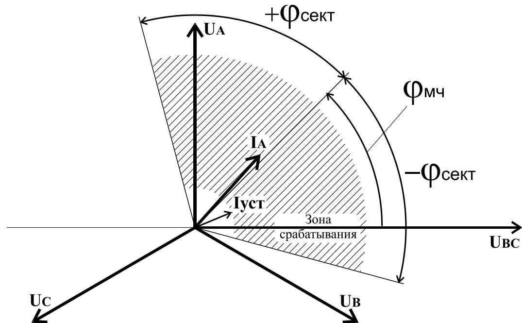
Рисунок 1 – Поясняющая диаграмма определения направления мощности
