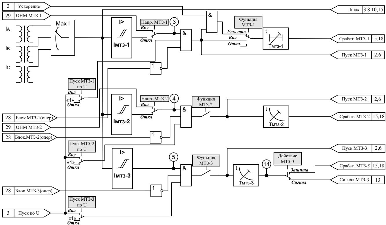
**Рисунок И.1 – Максимальная токовая защита (МТЗ)**
