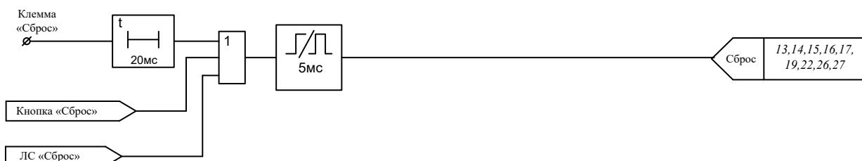
Рисунок И.30 – Сброс сигнализации
