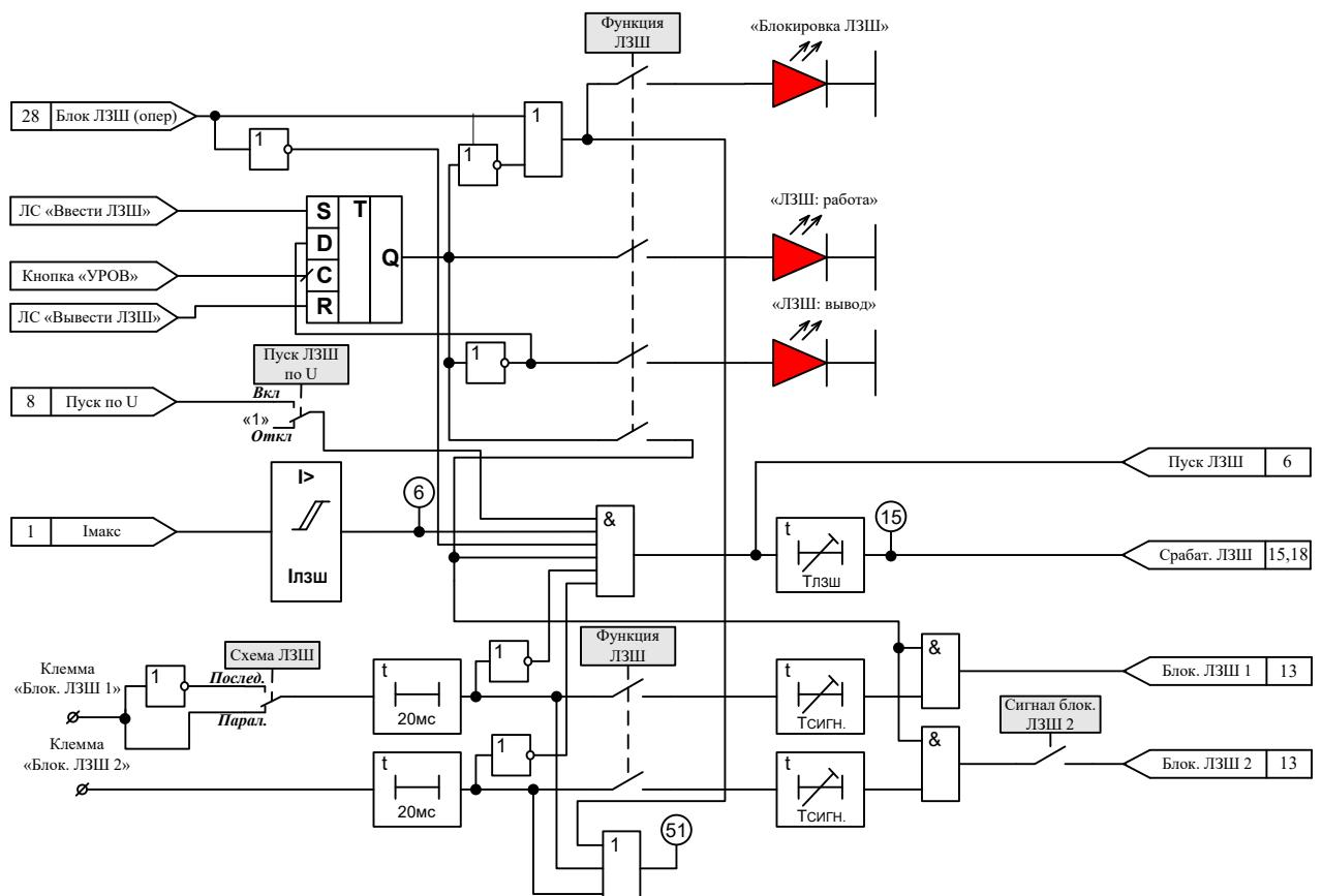
Рисунок И.3 – Логическая защита шин (ЛЗШ)
