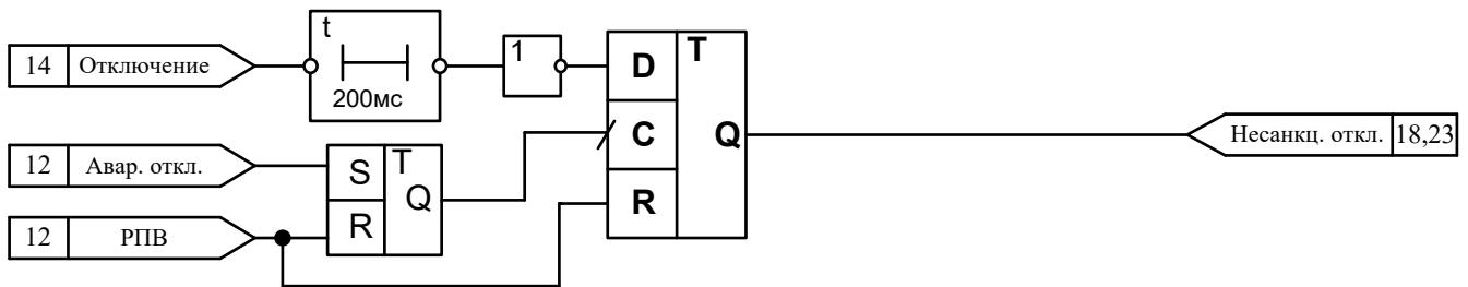
Рисунок И.20 – Формирование признака «Несанкционированное отключение»
