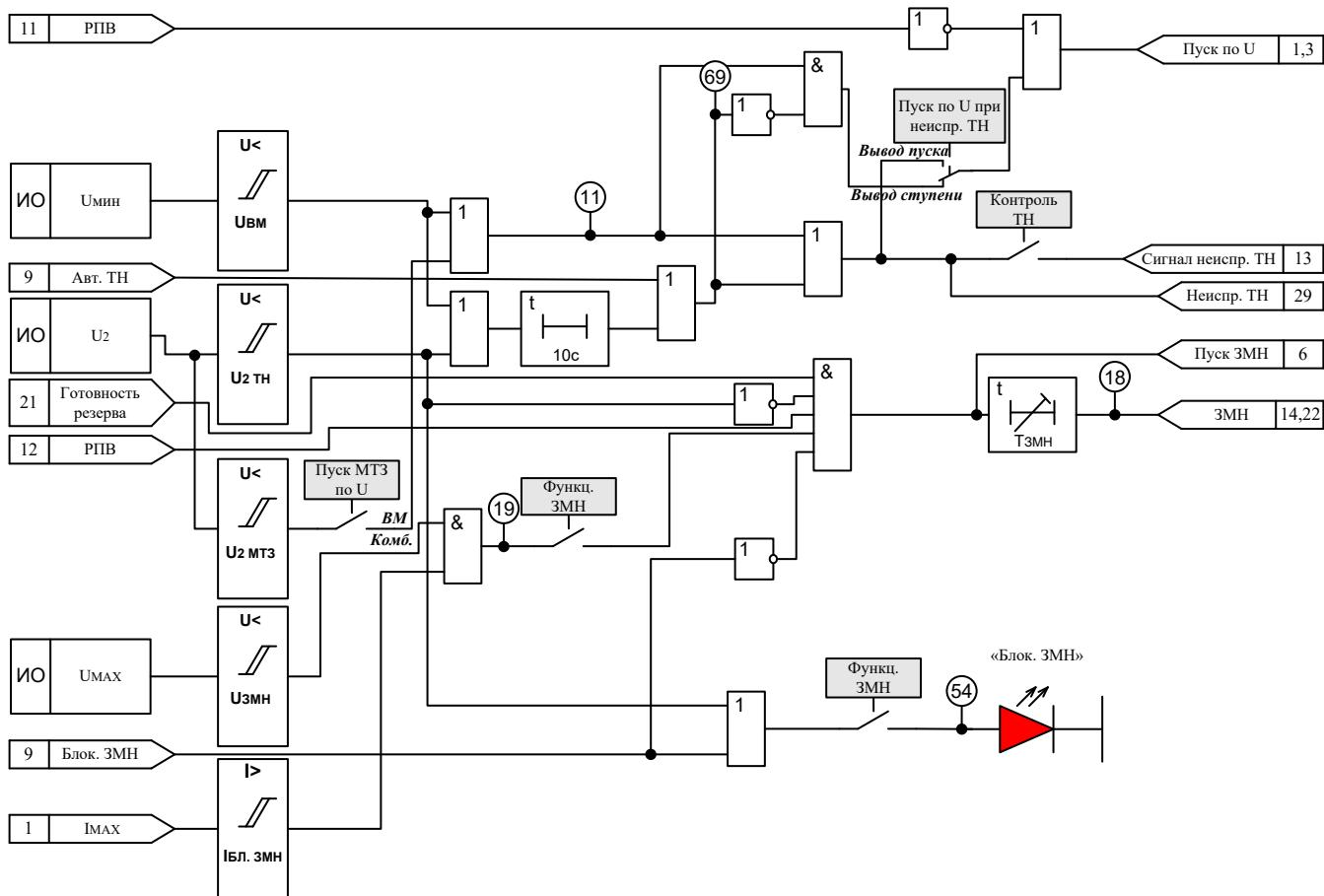
Рисунок И.8 – Защита минимального напряжения (ЗМН)
