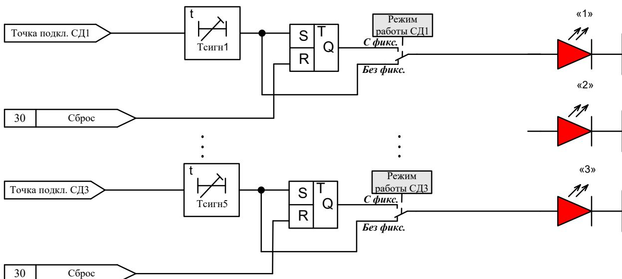
Рисунок И.27 – Программируемые светодиоды
