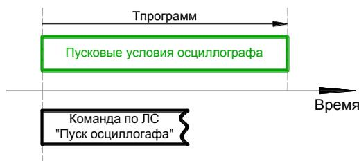
Рисунок 50 – Пусковые условия осциллографа при получении команды «Пуск осциллографа»
