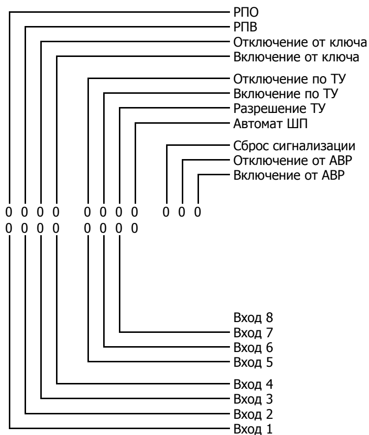
Рисунок В.1 – Соответствие входных дискретных сигналов в разделе «Контроль». Наличию сигнала на входе соответствует «1», отсутствию – «0».
