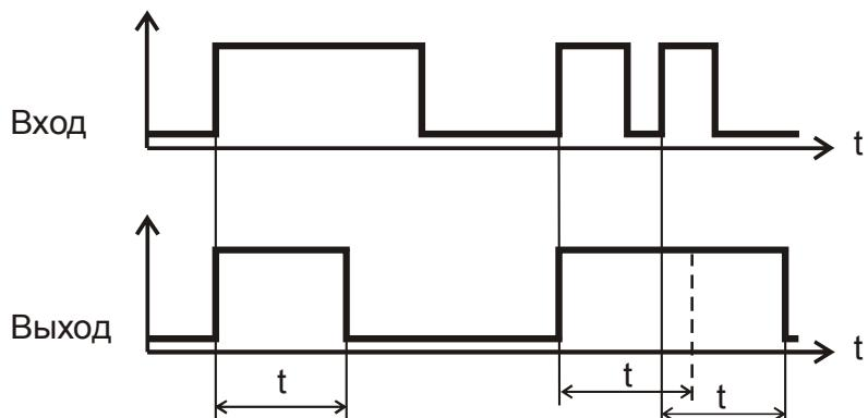
Если  $t$  на элементе не указано, то длительность выходного импульса равна одному программному циклу устройства (около 5 мс)
