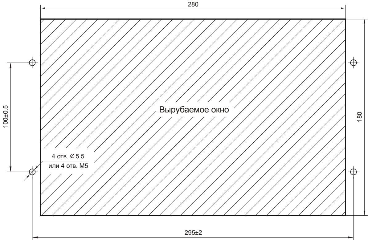
Рисунок Г.5 – Разметка панели под установку устройства
