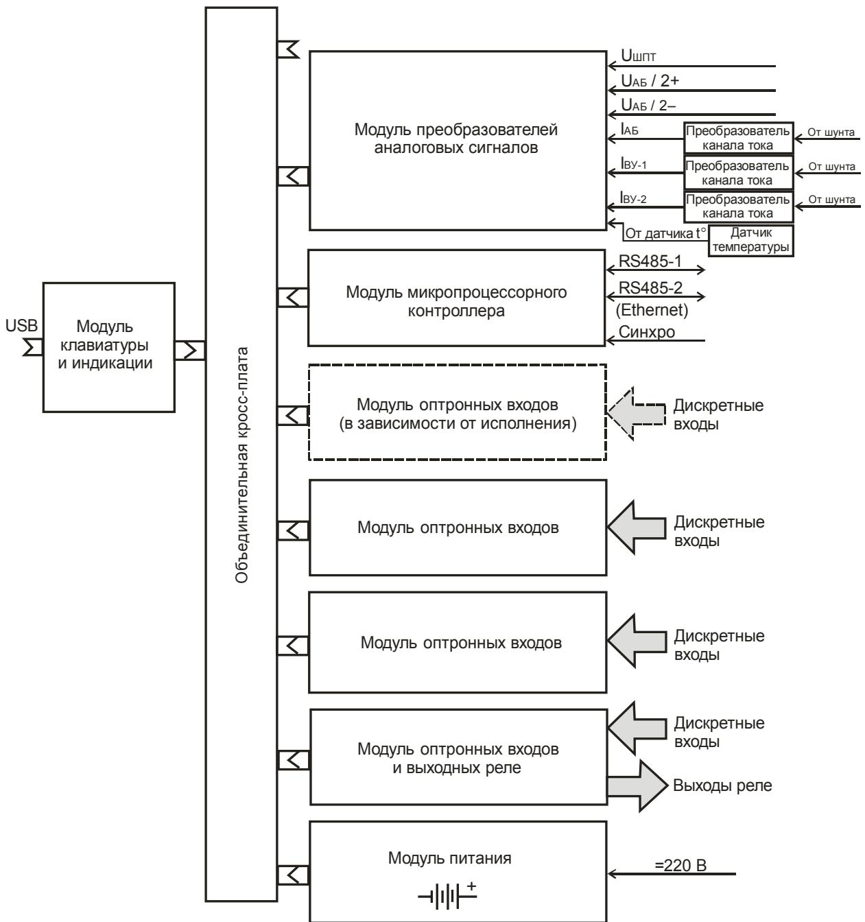
Рисунок 1.1 – Структурная схема устройства
