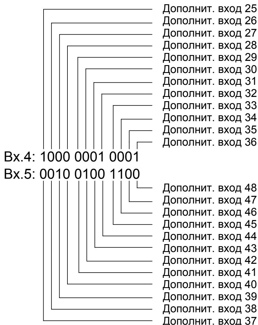
Рисунок В.2 – Соответствие входных дискретных сигналов в режиме «Контроль входов».
