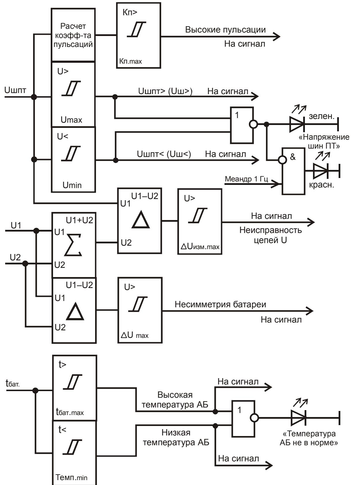
Рисунок Ж.5 – Фрагмент функциональной логической схемы обработки сигналов напряжения и температуры
