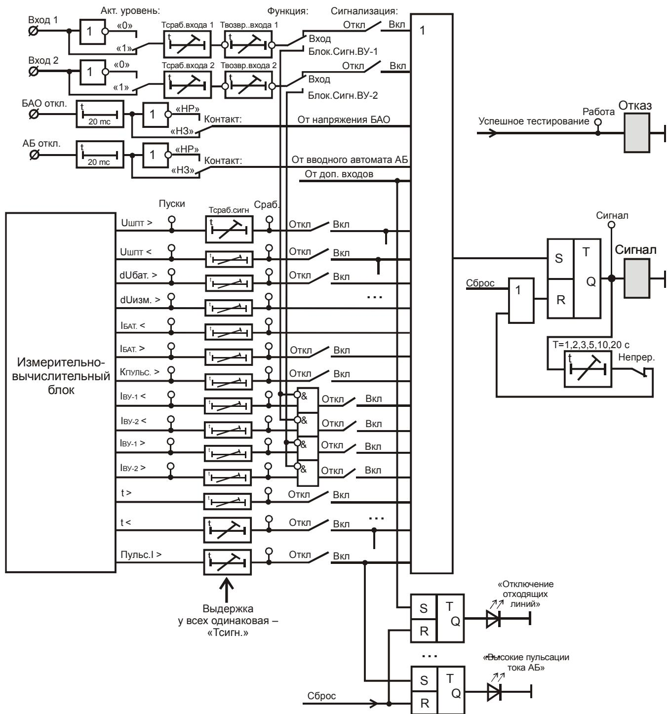
Рисунок Ж.4 – Фрагмент функциональной логической схемы выходного реле «Сигнал»
