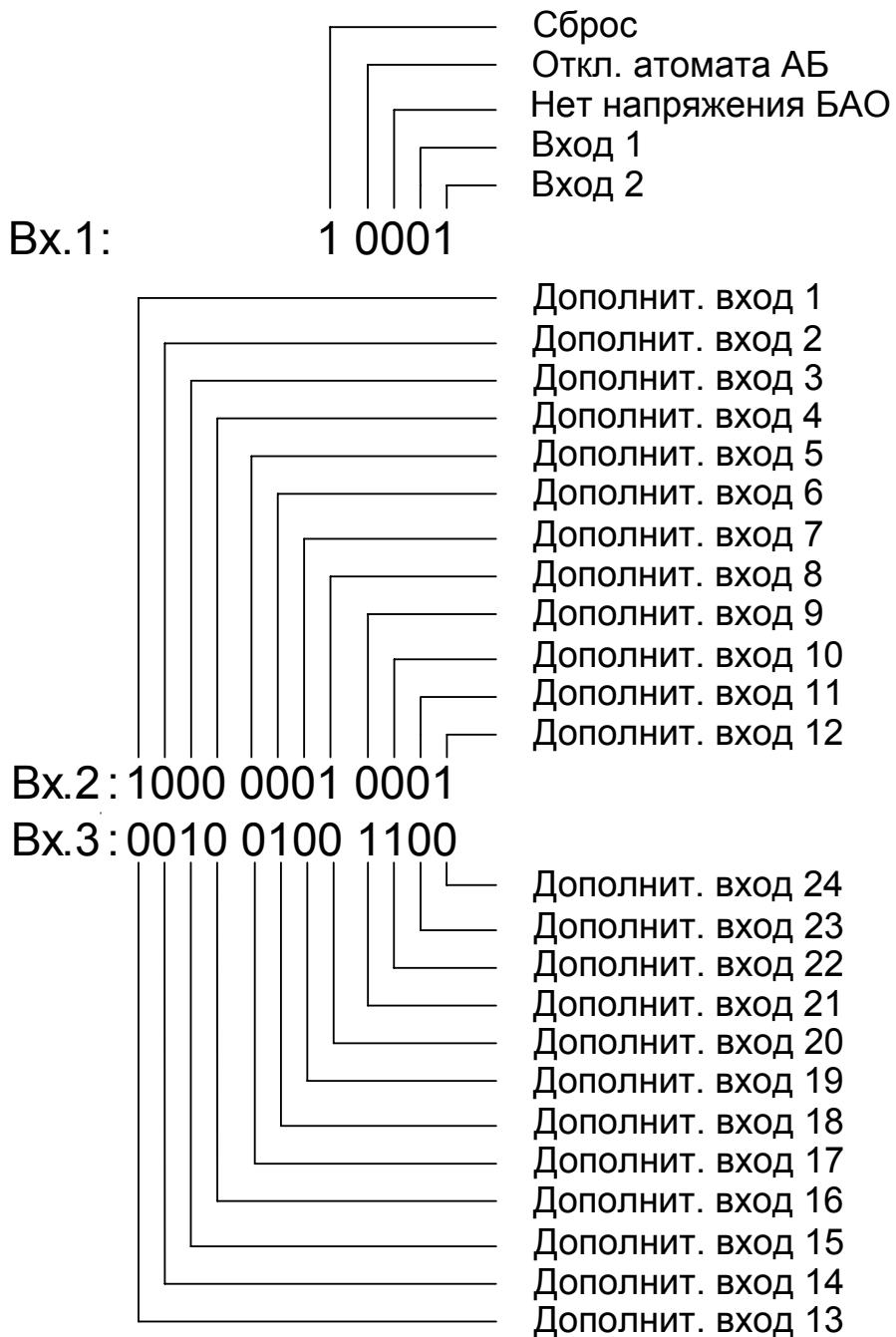
Рисунок В.1 – Соответствие входных дискретных сигналов в режиме «Контроль входов».
