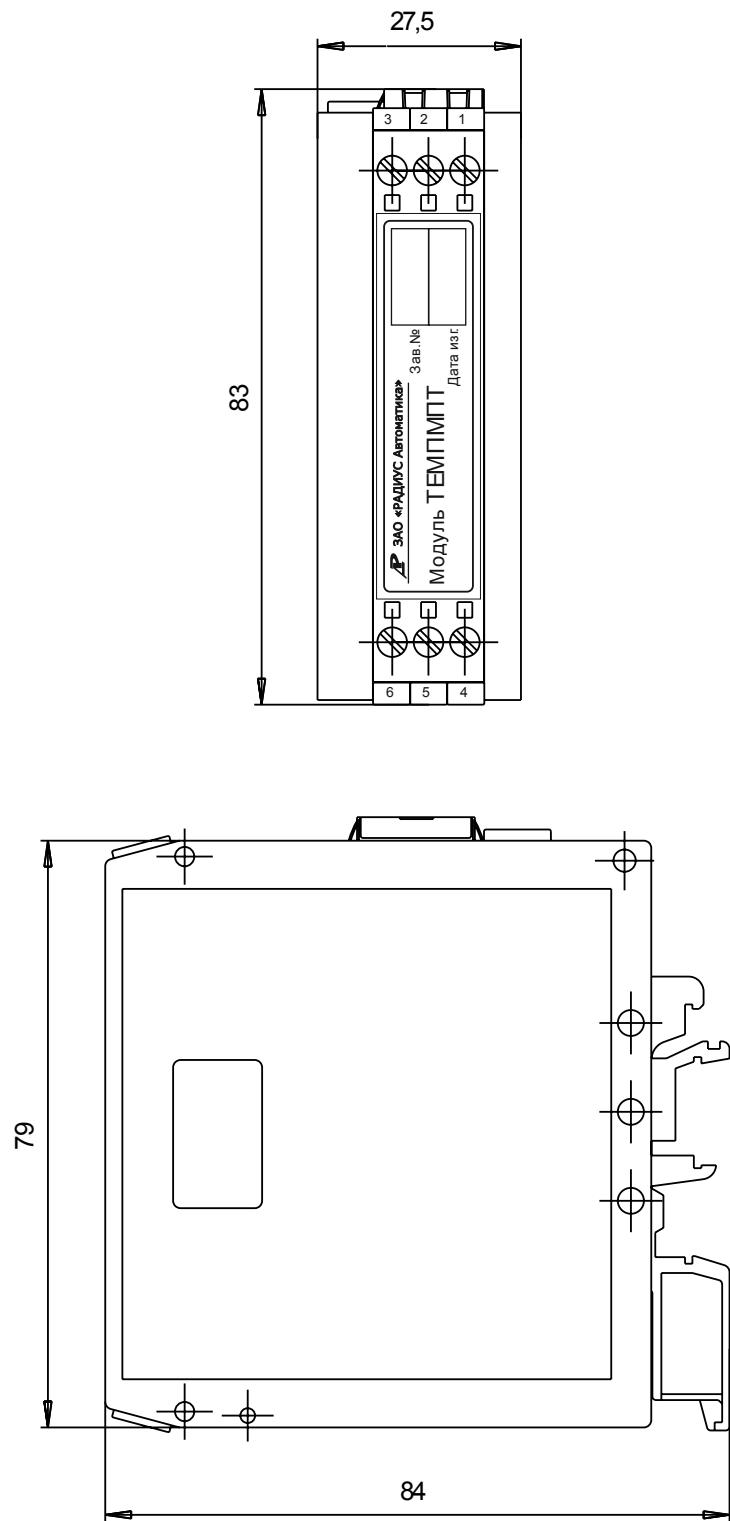
Рисунок Г.7 – Модуль датчика температуры ТЕМПМПТ
