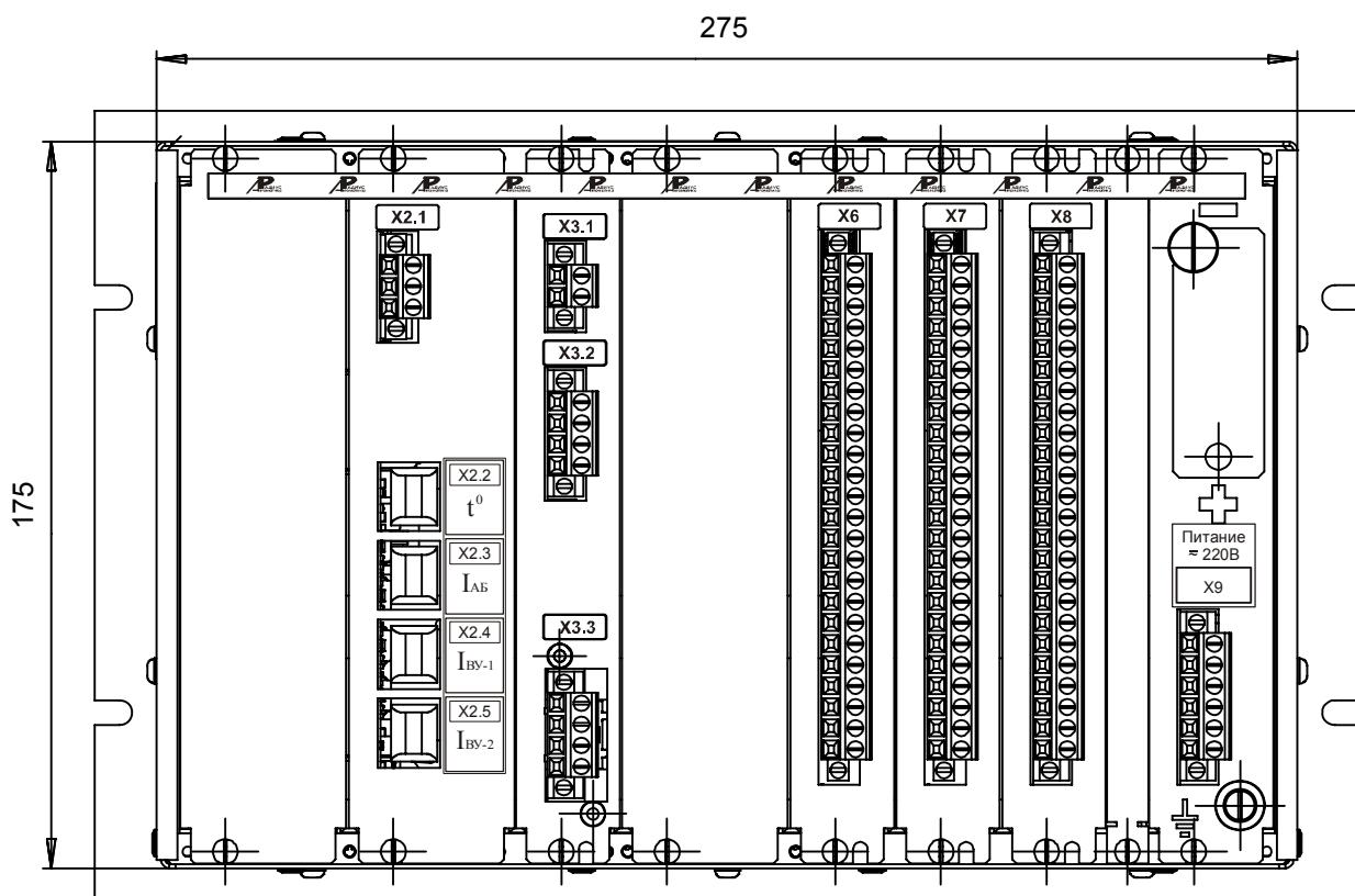
Рисунок Г.4 – Расположение элементов на задней панели устройства «Сириус-2-МПТ»
