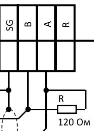
Рисунок Д.2 – Схема подключения устройств с интерфейсом RS485 в локальную сеть.
