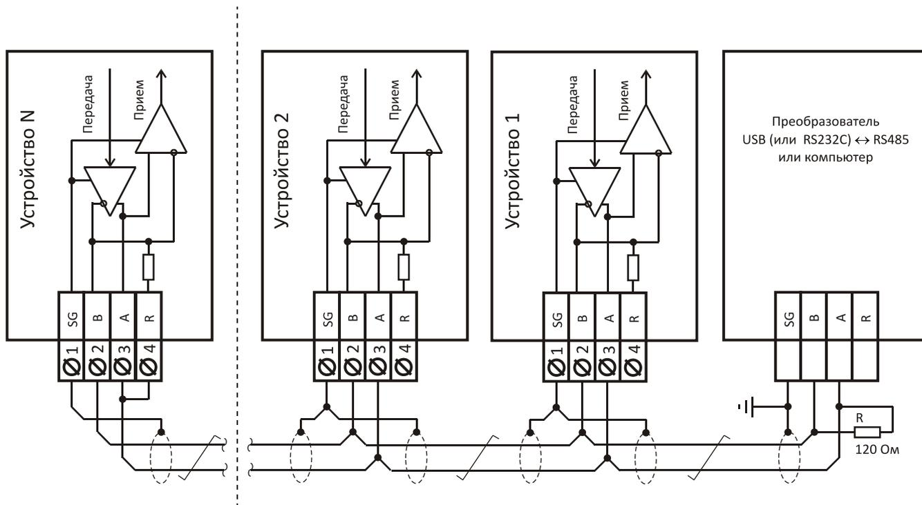
Рисунок Д.5 – Схема подключения устройств с интерфейсом RS485 в локальную сеть.
