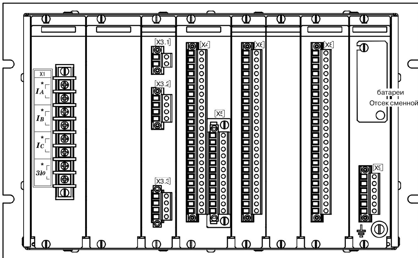
Рисунок Г.5 – Расположение элементов на задней панели устройства «Сириус-21-Л»
