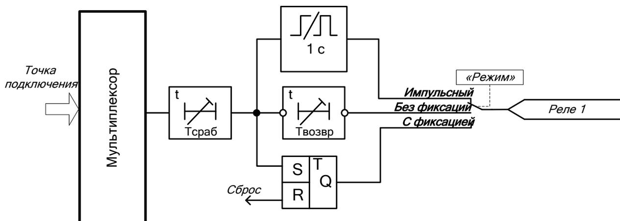
Рисунок 5 – Фрагмент функциональной логической схемы программируемого реле
