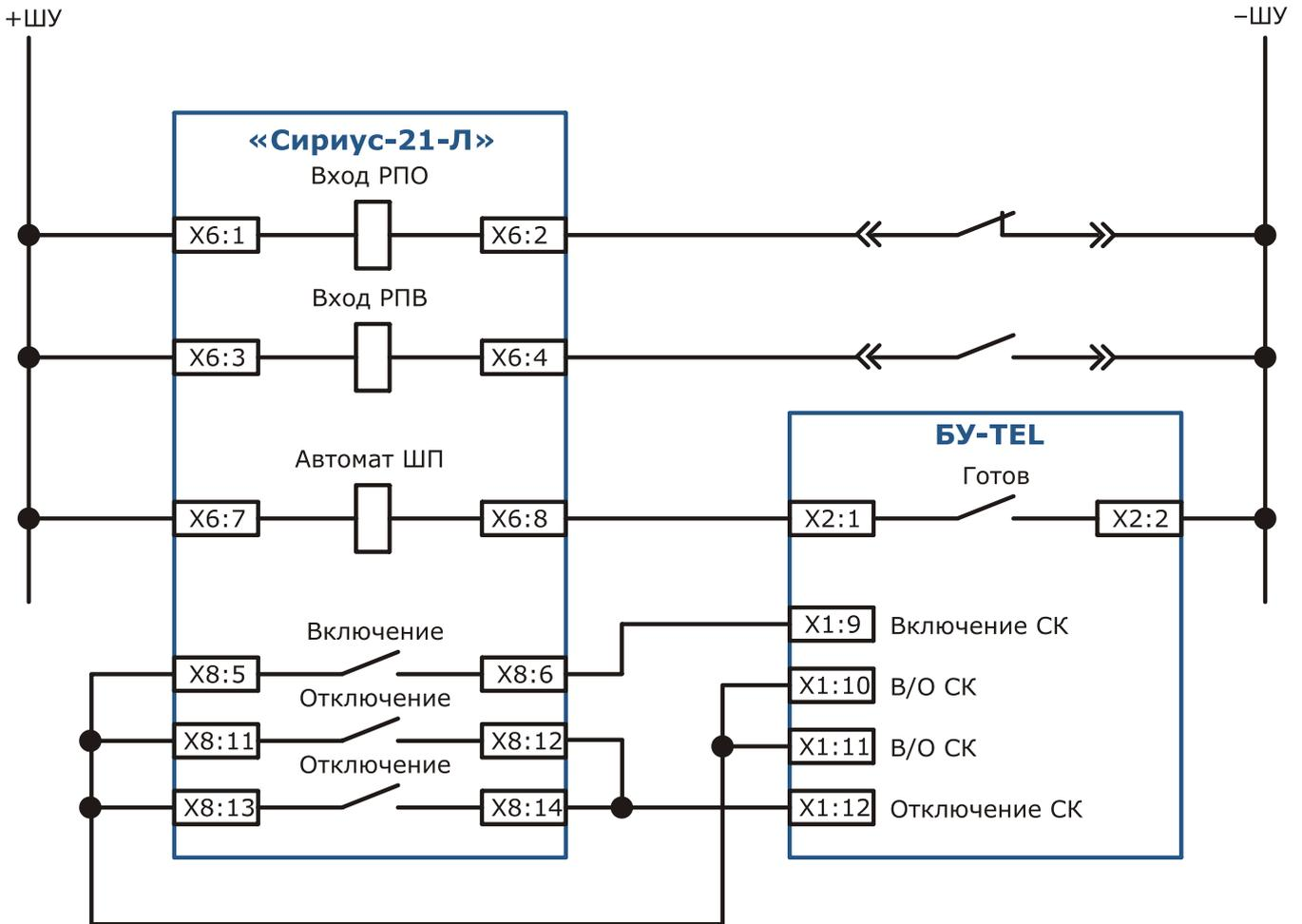
Рисунок Д.3 – Схема подключения устройства «Сириус-21-Л» к выключателю ВВ/TEL с блоком управления БУ/TEL-12 (для работы схемы установка «Вход АвШП» должна быть переведена в положение «Готов»)
