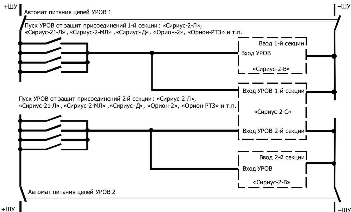
Рисунок Д.8 – Схема организации УРОВ на подстанции
