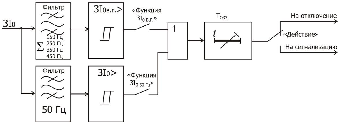
Рисунок 2 – Фрагмент функциональной логической схемы защиты от ОЗЗ
