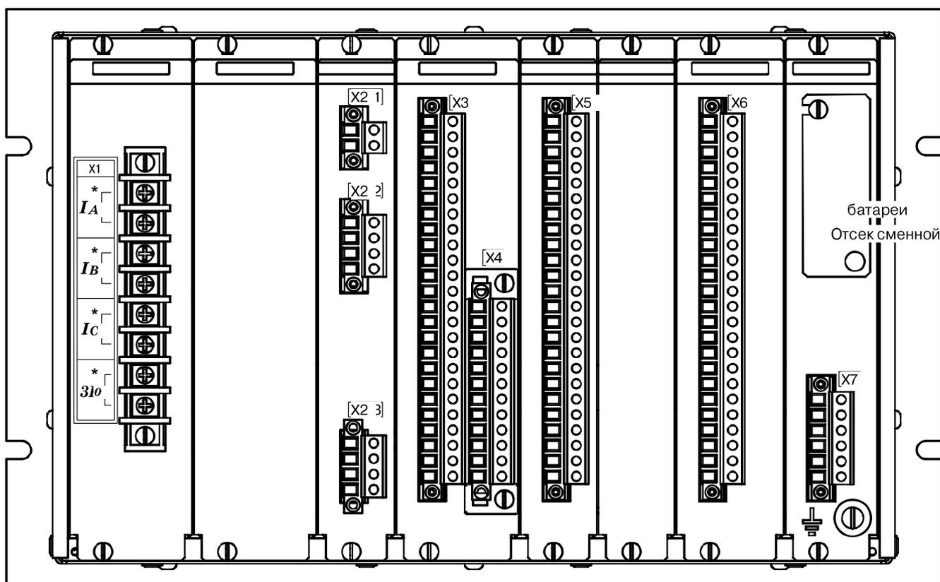
Рисунок Г.4 – Расположение элементов на задней панели устройства «Сириус-2-Л» в обычном корпусе
