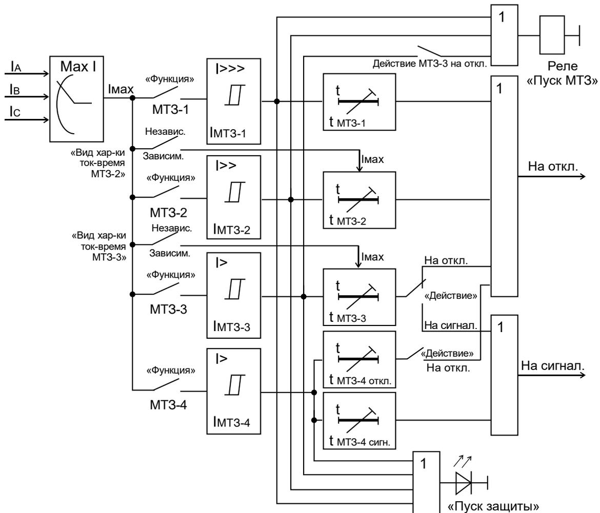
Рисунок 1 – Фрагмент функциональной логической схемы построения МТЗ
