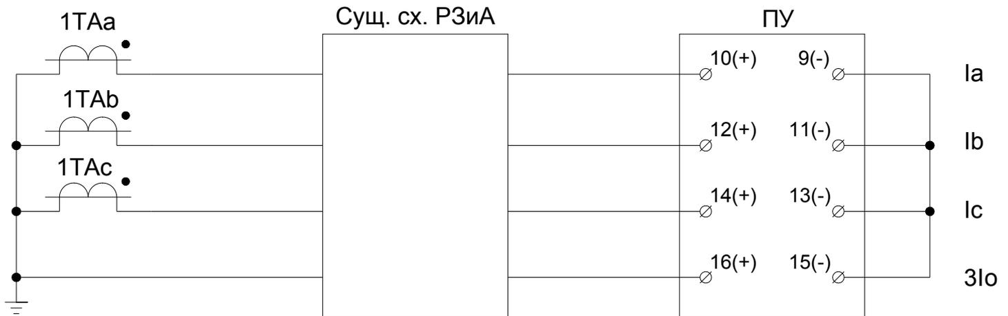
Рисунок 14 Схема подключение цепей переменного тока вариант 1
