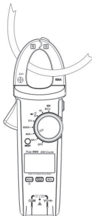
Рис 4. Измерение переменного тока
