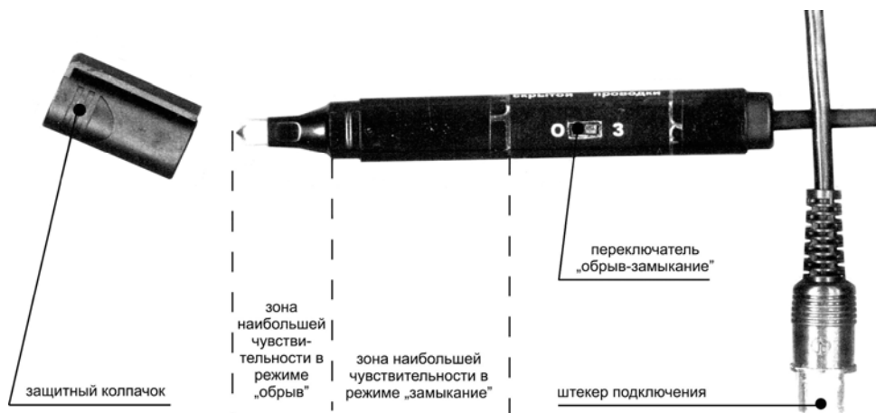
Рисунок 5.3.4.1 – Мини-датчик МД-01
