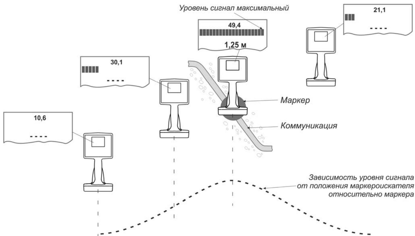
Рисунок 3.2б – Зависимость уровня сигнала от положения маркероискателя
