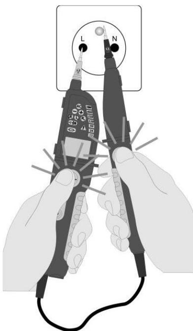
Тест заключается в принудительной подаче между фазой L и линией PE дифференциального тока, превышающего ток срабатывания выключателя УЗО.
