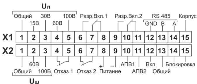
Рис. 2 Схема подключения устройства «Орион-КС»
