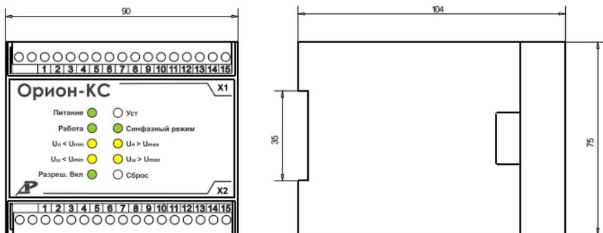
Рис. 1 Внешний вид и габаритные размеры устройства «Орион-КС»
