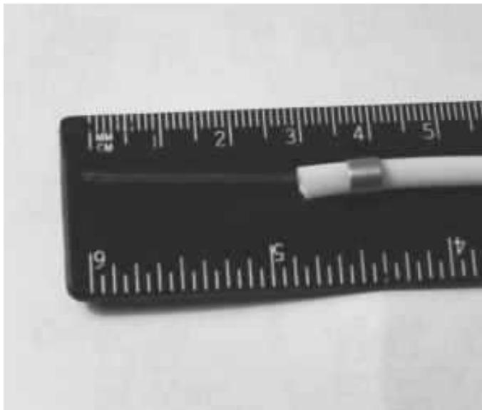
Рис 1. Расстояние от подготовленных торцов оптоволокна до защитного кембрика 30 мм.
