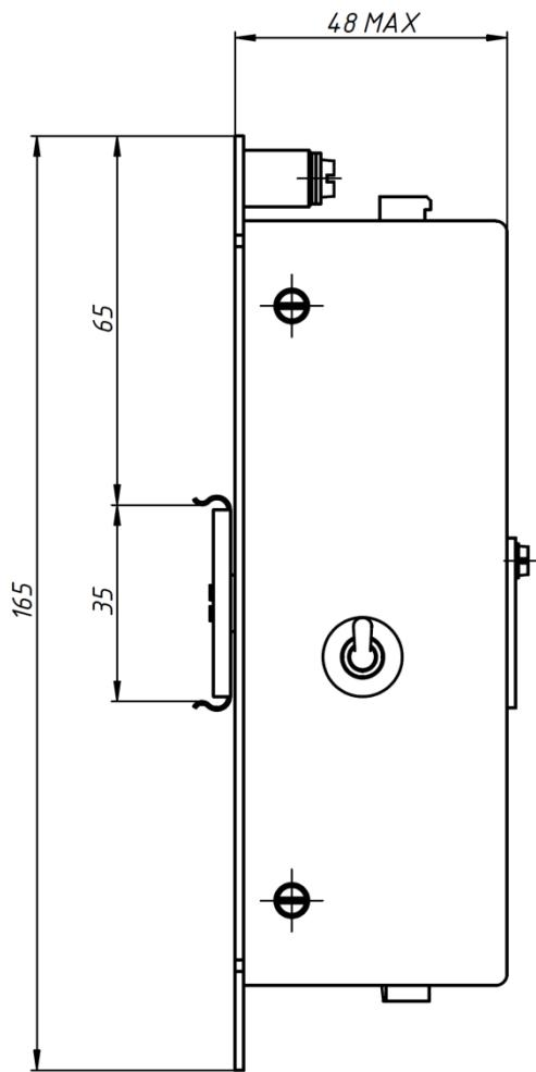
Рис. 12А. Внешний вид устройства «Орион-Д3» с креплением на DIN-рейку,
