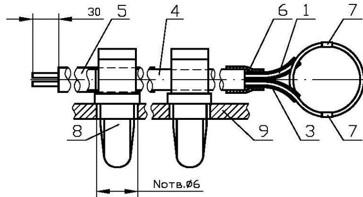
Рис. 14. Датчик дуги: 1 – основной световод, 3…5 – защитная оболочка световодов, 6 – термоусадочная трубка, 7 – место установки хомутиков (клипс) для фиксации приёмного кольца, 8 – клипсы, 9 – стенка, перегородка ячейки.
