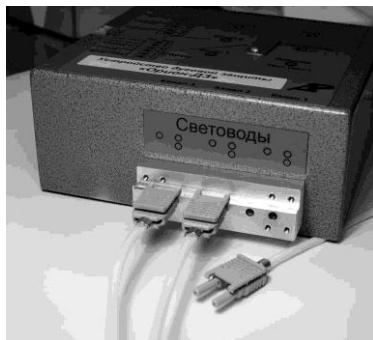
Рис. 7. Установить оптические коннекторы в оптический блок.
