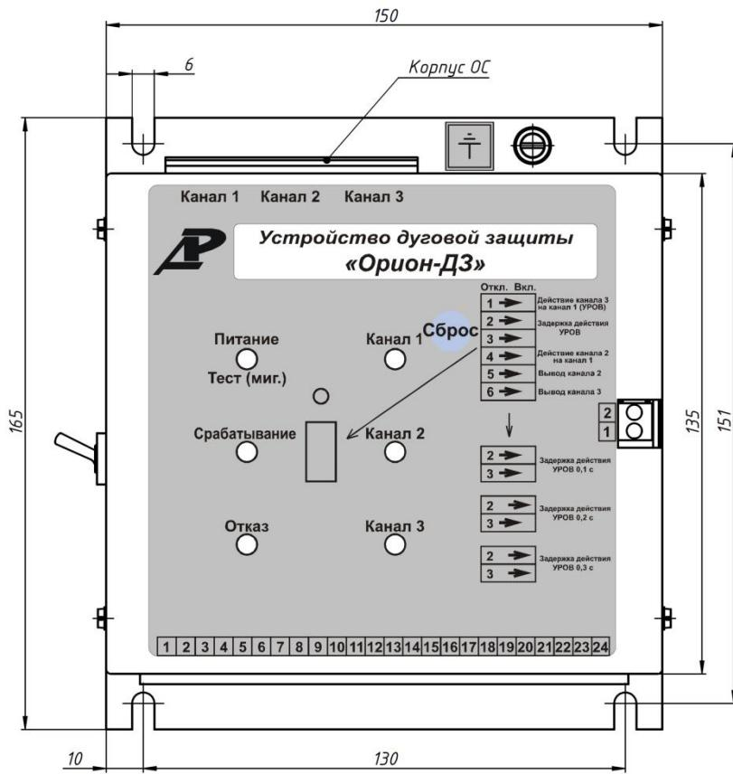
Рис. 12. Внешний вид устройства «Орион-Д3» с креплением под винт М5
