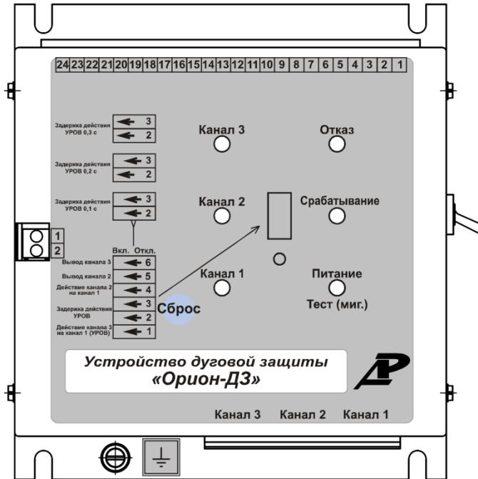
Рис 12 Б. Внешний вид устройства «Орион-Д3» с креплением под винт М5
