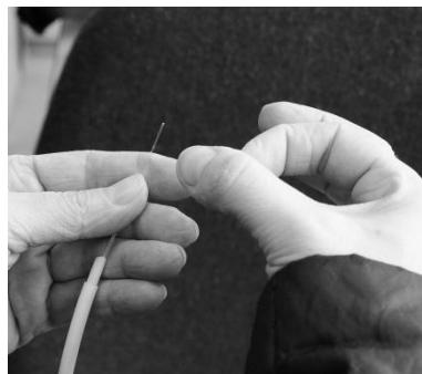
Рис. 10. Обламывание оптоволокна
