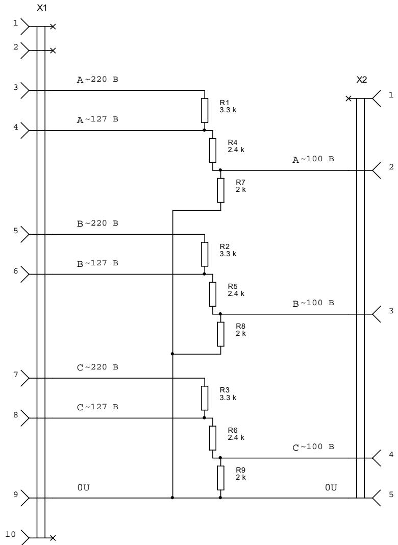
Рис. 2 Схема электрическая принципиальная делителя напряжения
