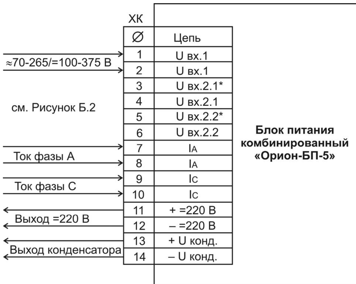
Рисунок Б.1 – Схема расположения клемм разъема ХК
