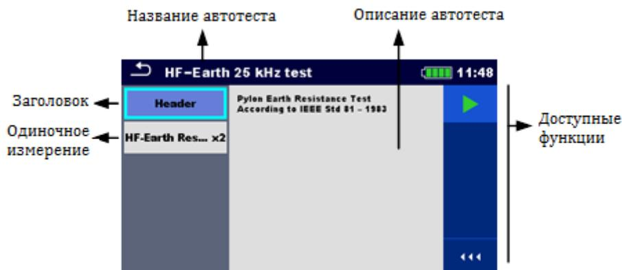
Рисунок 12.2: Меню просмотра автоматического измерения – выбран заголовок
