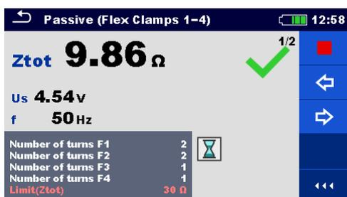
Рисунок 11.33: Примеры результатов пассивного измерения (гибкими клещами)
