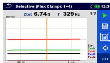
Рисунок 11.29: Пример графического отображения результатов селективного измерения (гибкими клещами)
