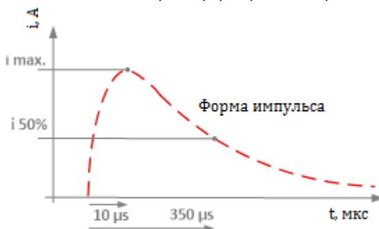
Рисунок 15.2: Типовая форма импульса короткого замыкания
