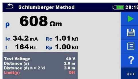
Рисунок 11.42: Пример результатов измерения методом Шлумбергера
