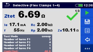
Рисунок 11.27: Пример цифрового отображения результатов селективного измерения (гибкими клещами) – Z<sub>tot</sub>
