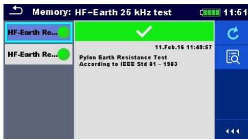
Рисунок 12.9: Окно памяти автоматического измерения
