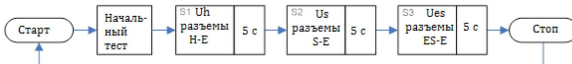
Рисунок 11.86: Блок-схема проверки вольтметра
