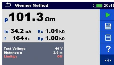
Рисунок 11.39: Пример результатов измерения методом Веннера
