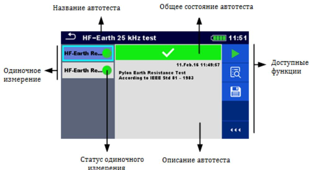
Рисунок 12.6: Окно результатов автоматического измерения
