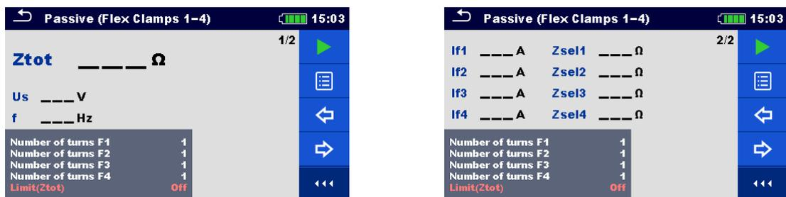
Рисунок 11.32: Меню пассивного измерения гибкими клещами
