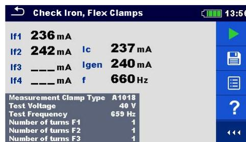
Рисунок 11.93: Пример результатов железных, гибких клещей.
