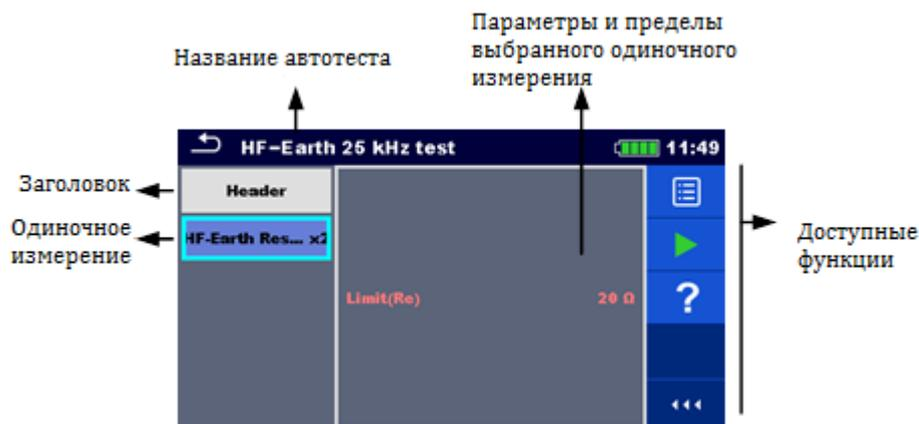
Рисунок 12.3: Меню просмотра автоматического измерения – выбраны измерения.
