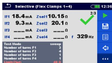
Рисунок 11.28: Пример цифрового отображения результатов селективного измерения (гибкими клещами) – Z<sub>sel1-4</sub>
