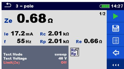
Рисунок 11.8: Пример цифрового представления результата 3-проводного измерения
