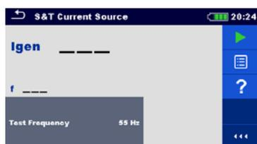
Рисунок 11.69: Меню генерируемого тока для напряжения прикосновения и шагового напряжения
