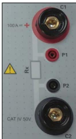
**Рисунок 4.2:** Клеммы тока и напряжения прибора MicroOhm 100A
