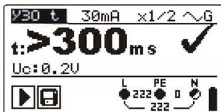
Рисунок 5.14: Пример результатов измерения времени срабатывания
