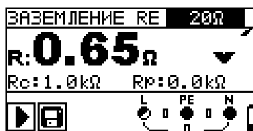
Рисунок 5.30: Пример результатов измерения сопротивления заземления
