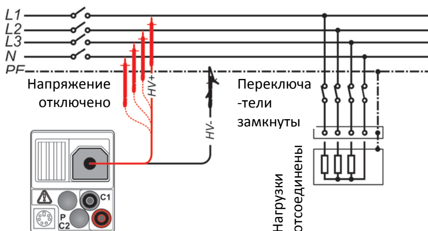
Рисунок 5.7: Подключение 2.5 кВ тестового кабеля) ( U_N = 2.5 \text{ кВ} )
