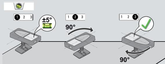
Дважды повернуть прибор по направлению движения часовой стрелки на  $90^\circ$ . Следуйте инструкциям на дисплее. Выравнивание завершено после появления иконки "OK" на дисплее.
