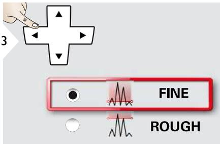
Выбрать чувствительность выравнивания, требуемую для некоторых функций измерения. "FINE" значит, что выравнивание прибора чувствительно к любым небольшим вибрациям. Выберите "ROUGH" при работе в жестких условиях на стройплощадке с большим количеством грузов и вибраций. В этом случае точность уменьшается в зависимости от движения.
