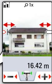
Выбрать стрелки с помощью курсорных клавиш, или нажав на сенсорный экран, и выберите нужные значения с помощью сенсорных клавиш. Рассчитана соответствующая ширина.
