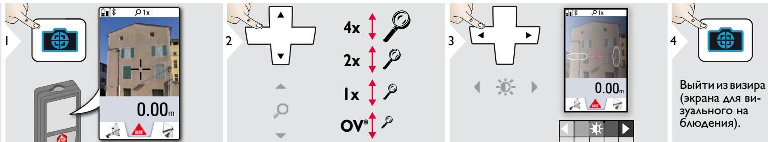
**i** Прибор является отличным помощником при выполнении измерений на открытом воздухе. Встроенный визир (экран для визуального наблюдения) отображает цель на дисплее. Прибор производит измерение в центре окулярной сетки, даже если лазерная точка не видна. Ошибки параллакса возникают, если камера визира используется для близких целей, вызывая эффект, когда лазер оказывается смещенным на окулярной сетке. В этом случае ошибка автоматически корректируется со сдвигом окулярной сетки.
