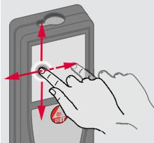
Сдвиньте дисплей, чтобы перейти к предыдущему или следующему экрану в функции галереи.
