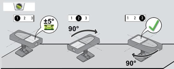
Дважды повернуть прибор по направлению движения часовой стрелки на  $90^\circ$ . Следуйте инструкциям на дисплее. Выравнивание завершено после появления иконки "OK" на дисплее.
