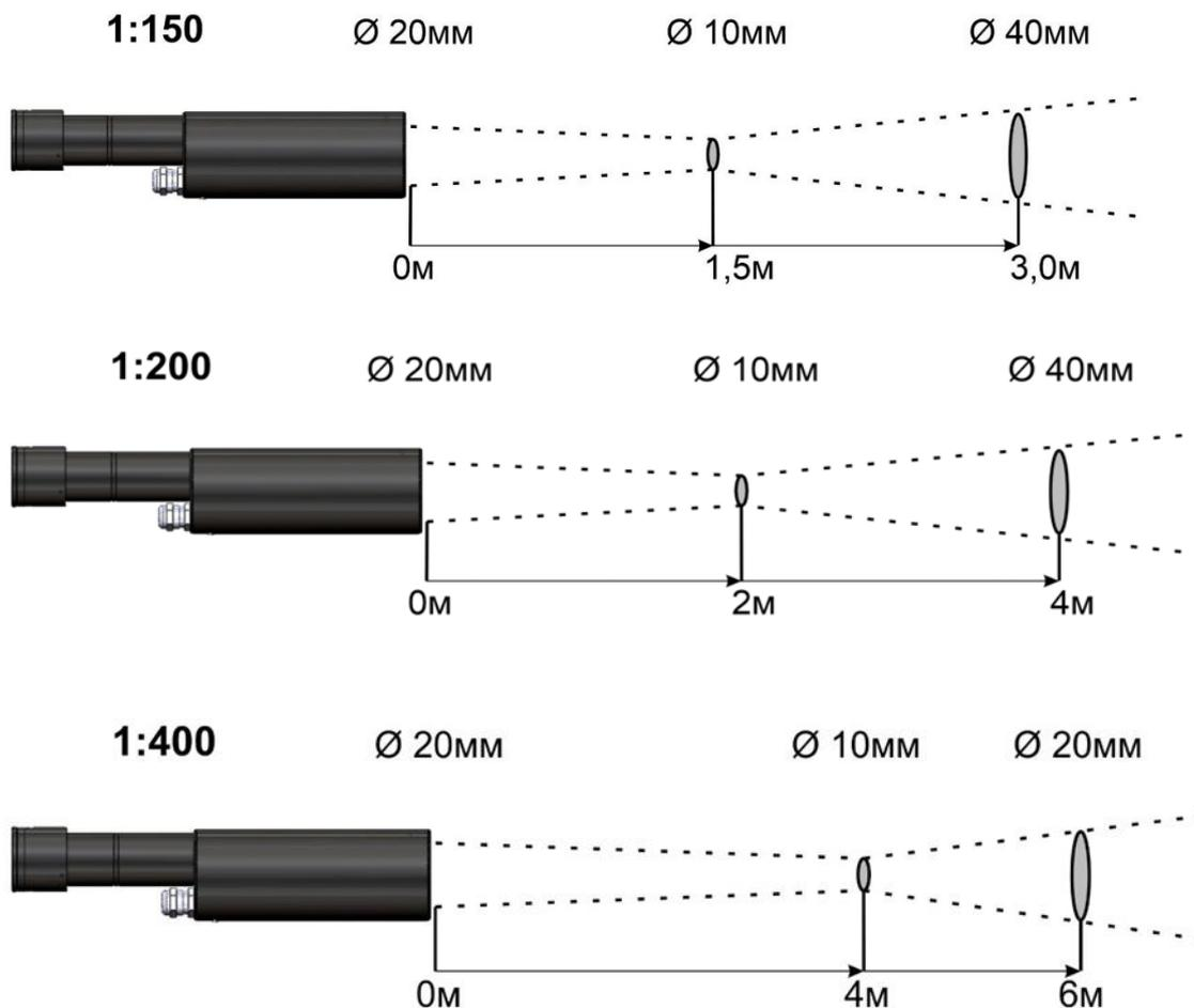
**Измеряемый диаметр объекта** определяется показателем визирования и зависит от расстояния до инфракрасного пирометра:
