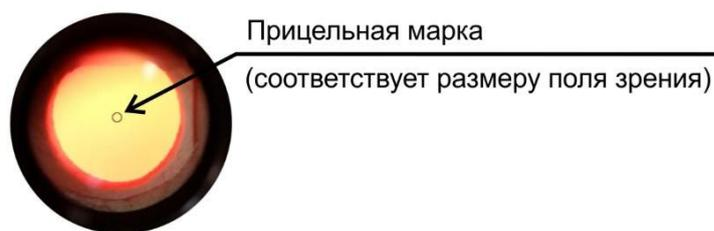
Для ослабления яркого излучения от сильно нагретых объектов используется поляризационный светофильтр, который смонтирован на окуляре пирометра. При слишком ярком свечении объекта пользователь вращением кольца светофильтра на окуляре добивается его ослабления до комфортного наблюдения.
