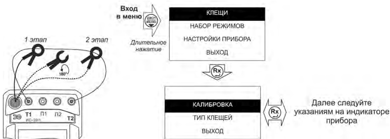
Рисунок 2.14 – Калибровка токоизмерительных клещей
